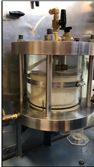
Figura 3.6. Montaje completo de una muestra de suelo
