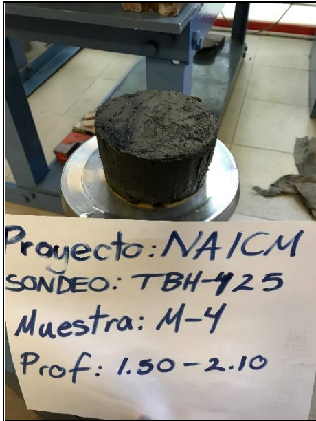
Figura D.1. Probeta correspondiente a la costra superficial
