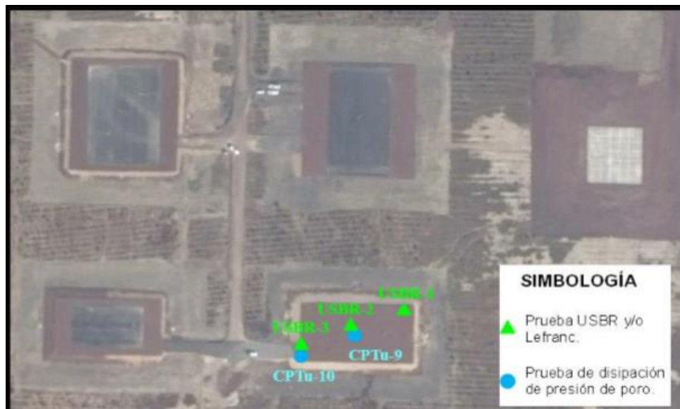
Figura 2.3. Localización de pruebas de permeabilidad (2014) en la Zona 1 de la Fig. 2.2
