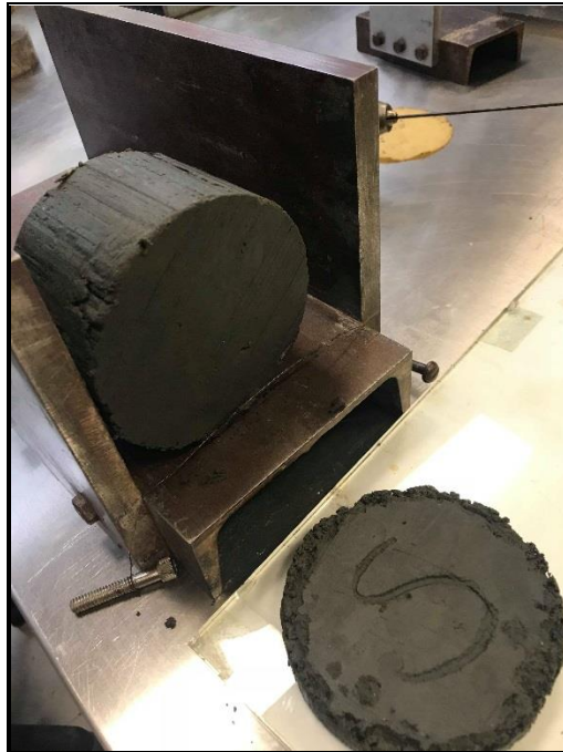
Figura 3.3. Muestra de suelo extraída del tubo (perímetro exterior con irregularidades).
