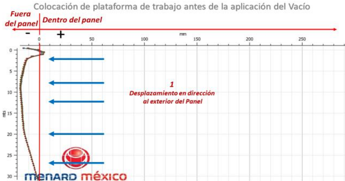
Figura 64.- “Desplazamiento al colocar la plataforma de trabajo.” Fuente: Menard México.
