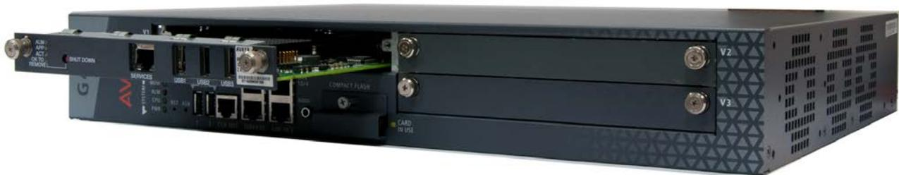
Figura 3.1.2 Media Server S8300D en el Slot V1 de un Media Gateway G430
