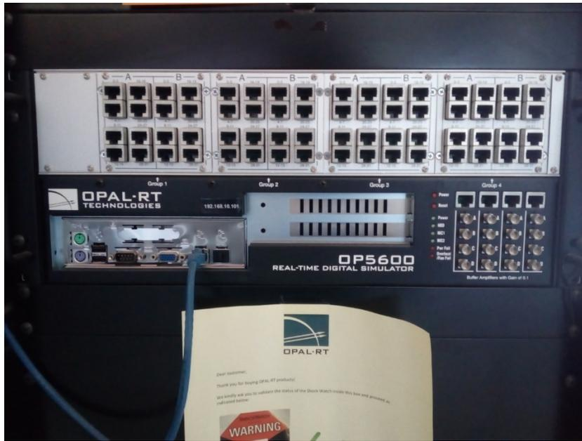
Figura 91. Panel frontal de conexión de la OP5600 de la UAT
