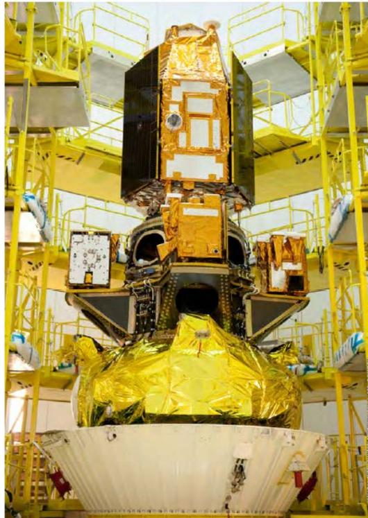
Figura 26. ASAP-S listo para proceder con el encapsulamiento. [13]
