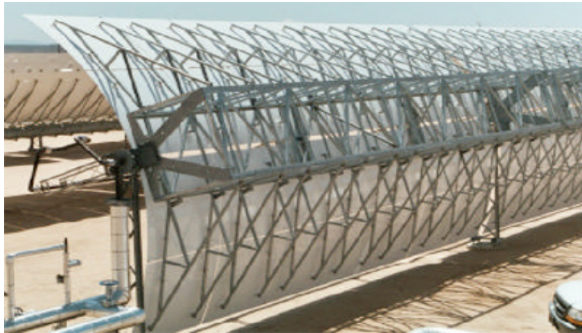
Figura 28, Estructura de un captador EuroTrough (BMU, 2009)
