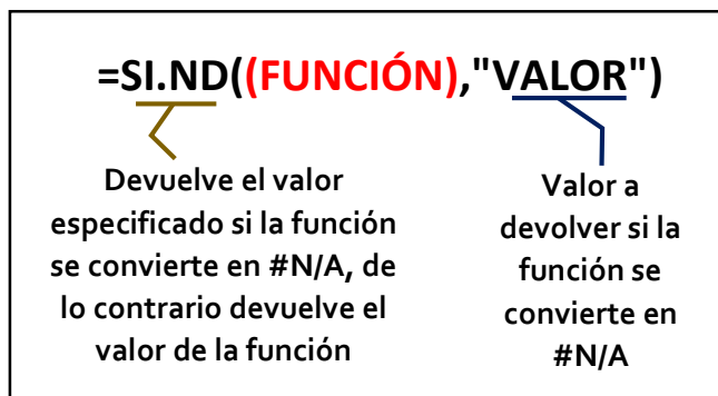
Figura 37 Estructura de la función SI.ND. Fuente: Elaboración propia.
