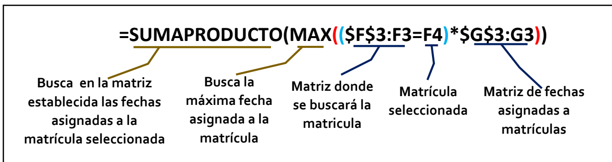
Figura 322 Estructura de la función SUMAPRODUCTO. Fuente: Elaboración propia.
