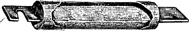
2. En una sobrecarga sostenida, una sección del eslabón se funde y se establece un arco.
