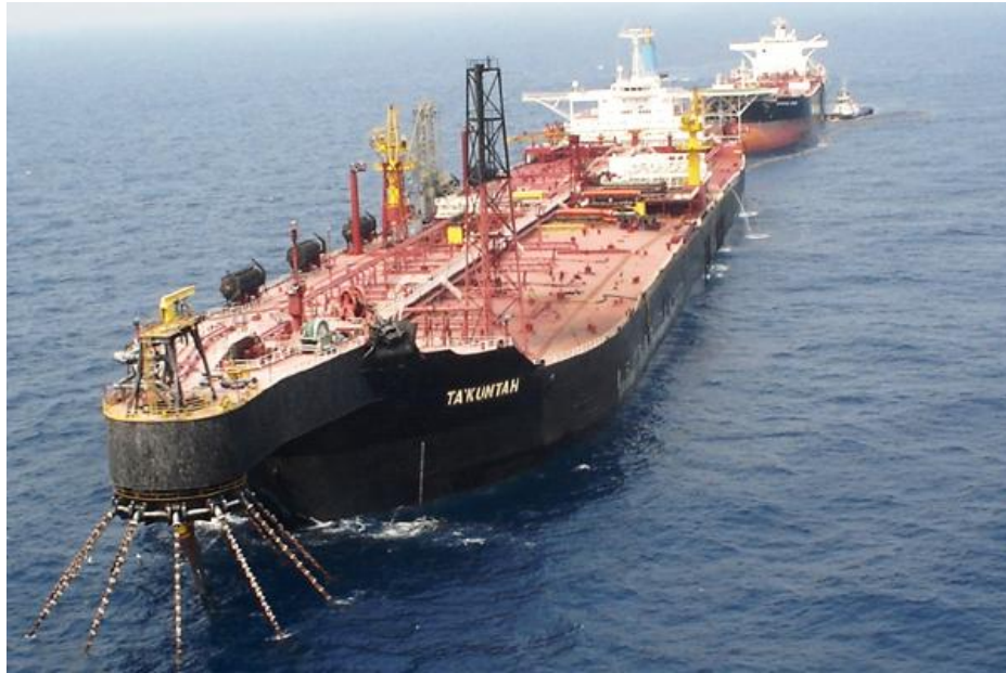
Figura 2. FSO TaKuntah (PEMEX) en operación en el campo Cantarell (Fuente: www.modec.com ).
