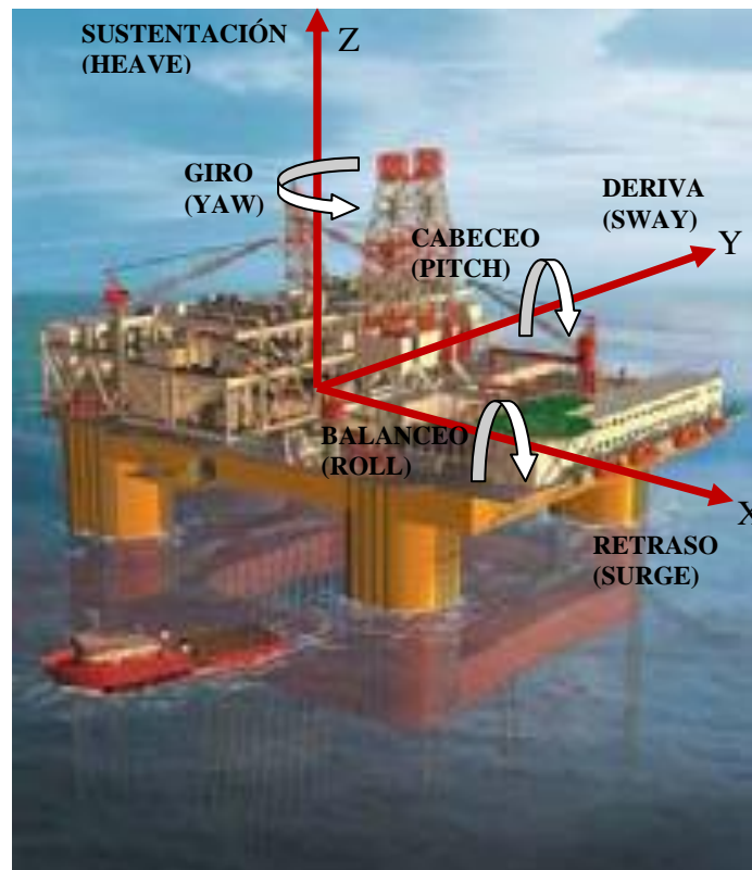
Figura I.2. Grados de libertad de un sistema flotante (Fuente: Smedvig Offshore, 2005).
