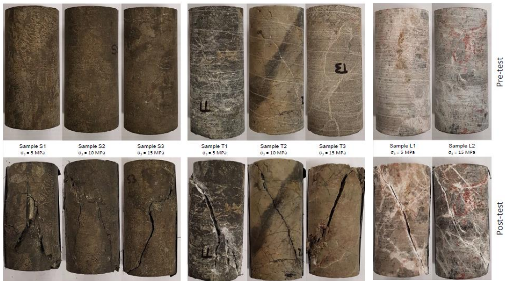
Figura 24.- Fotografías de testigos antes y después de las pruebas, de izquierda a derecha; Mineral, Toba Dacítica y Caliza.
