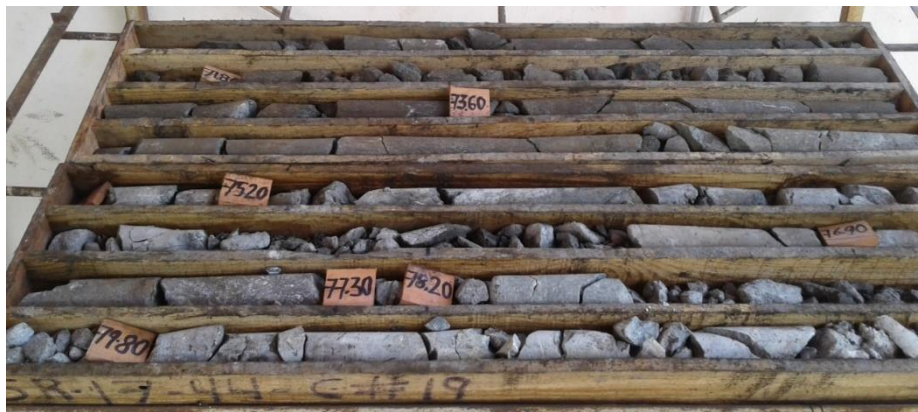
Figura 32. - Ejemplo de barreno utilizado para la obtención del RQD, en la fotografía se aprecia el contacto entre el Mineral y la Caliza al bajo del yacimiento.
