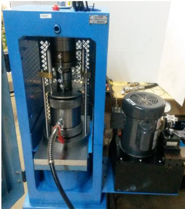
Figura 23.- Prensa utilizada en pruebas triaxiales.
