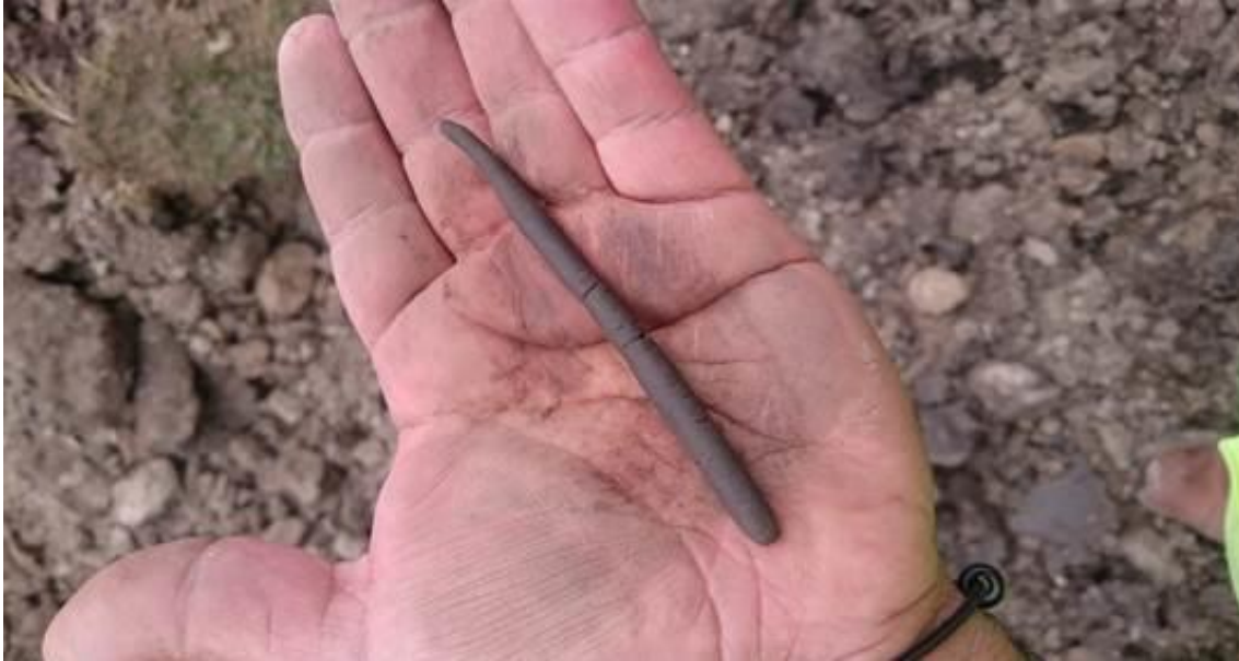
Ilustración 16 El suelo encontrado en algunas zonas del tramo 3 muestra plasticidad, característica de suelos arcillosos.
