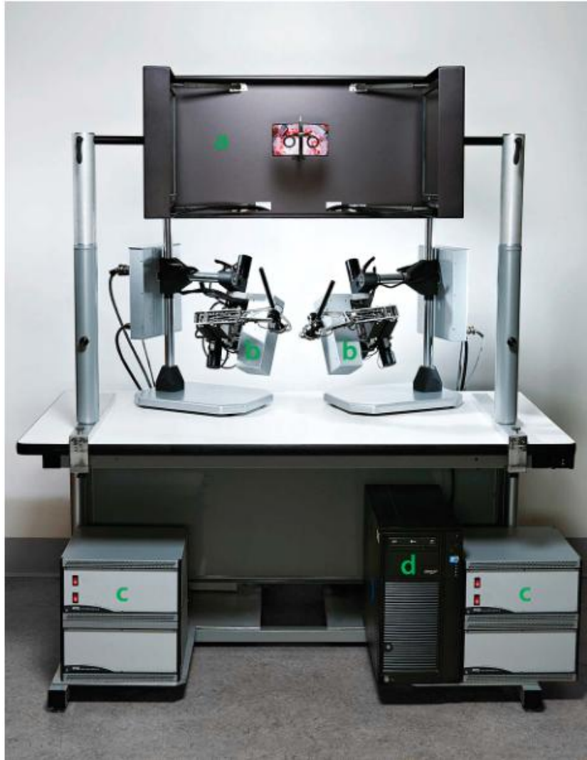
Figura 10. Componentes de NeuroTouch. Estereoscopio (a), sistemas hápticos (b), fuentes de alimentación y amplificadores para sistemas hápticos (c), computadora (d). Imagen extraída de (Delorme et al., 2012, p. 4)
