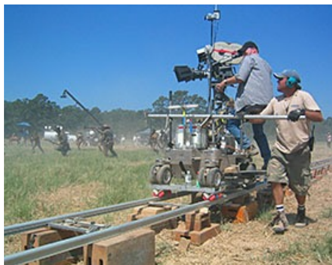
Figura 1.3: Sistema dolly usado en filmaciones profesionales.
