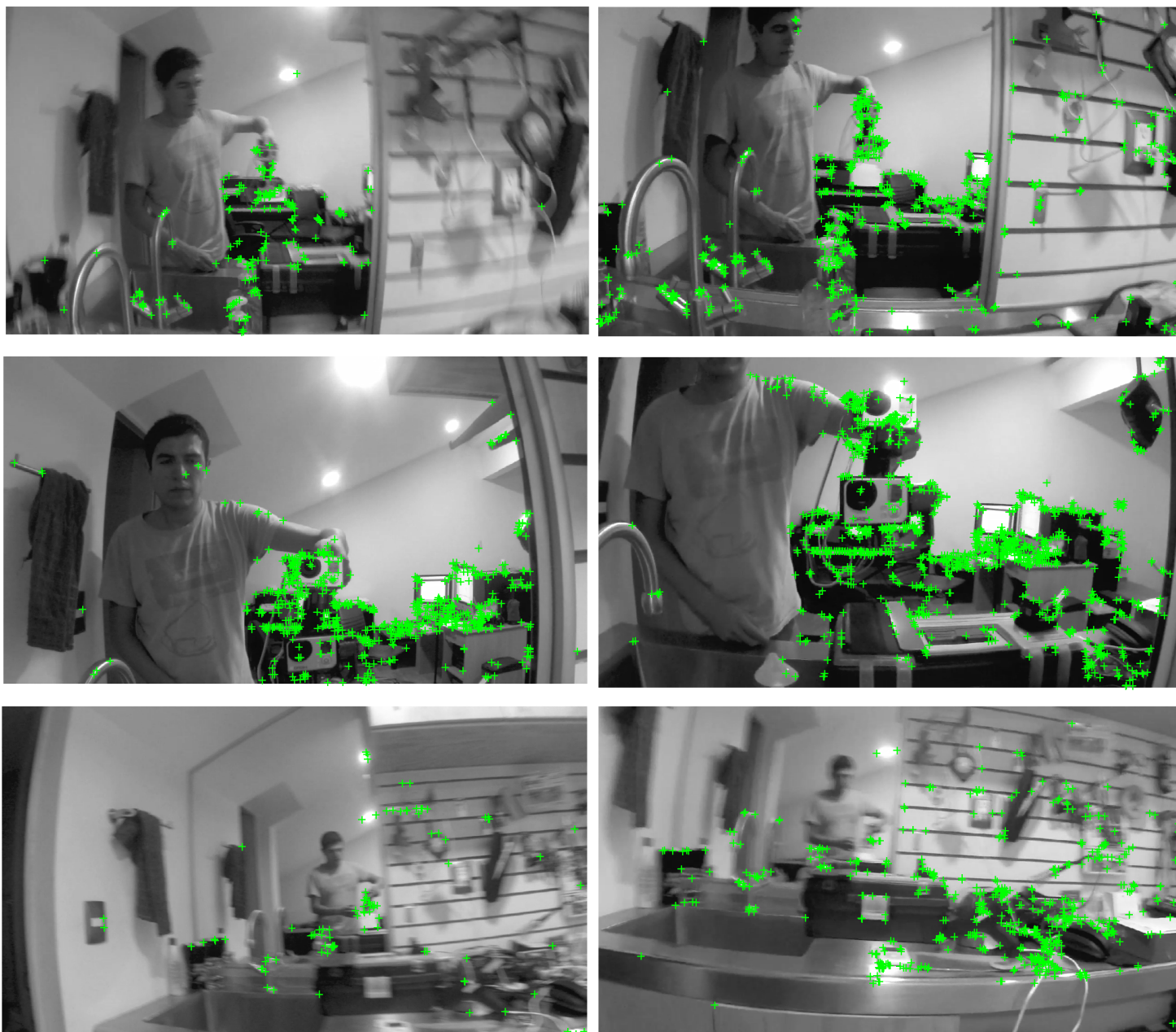
Figura 4.10: Esquinas detectadas en ambos videos (con-sin estabilización) utilizando el algoritmo FAST para los cuadros 237, 379 y 473
