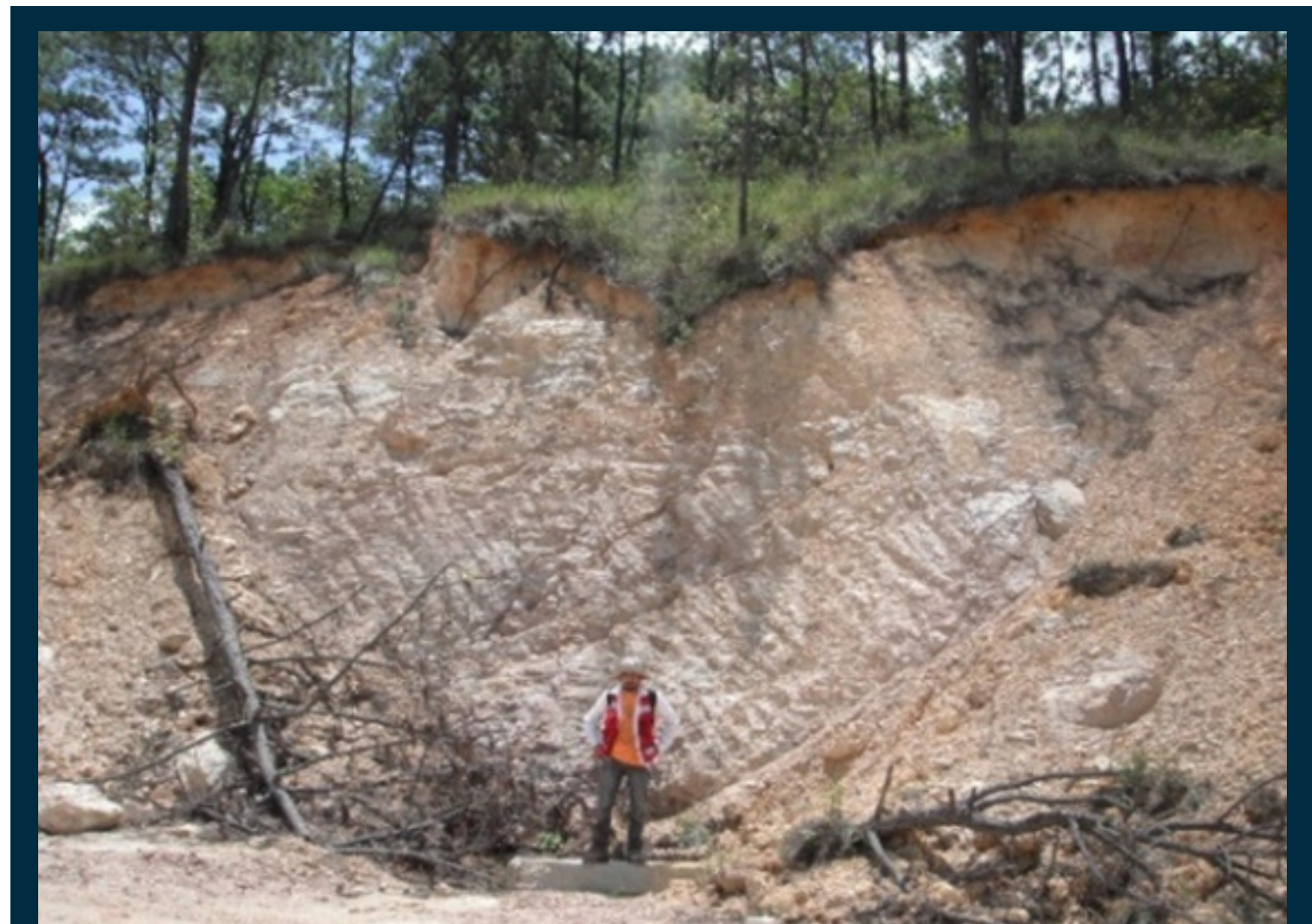
Figura 3.6b Superficie donde se observan los planos de esquistosidad que son casi paralelos al corte.
