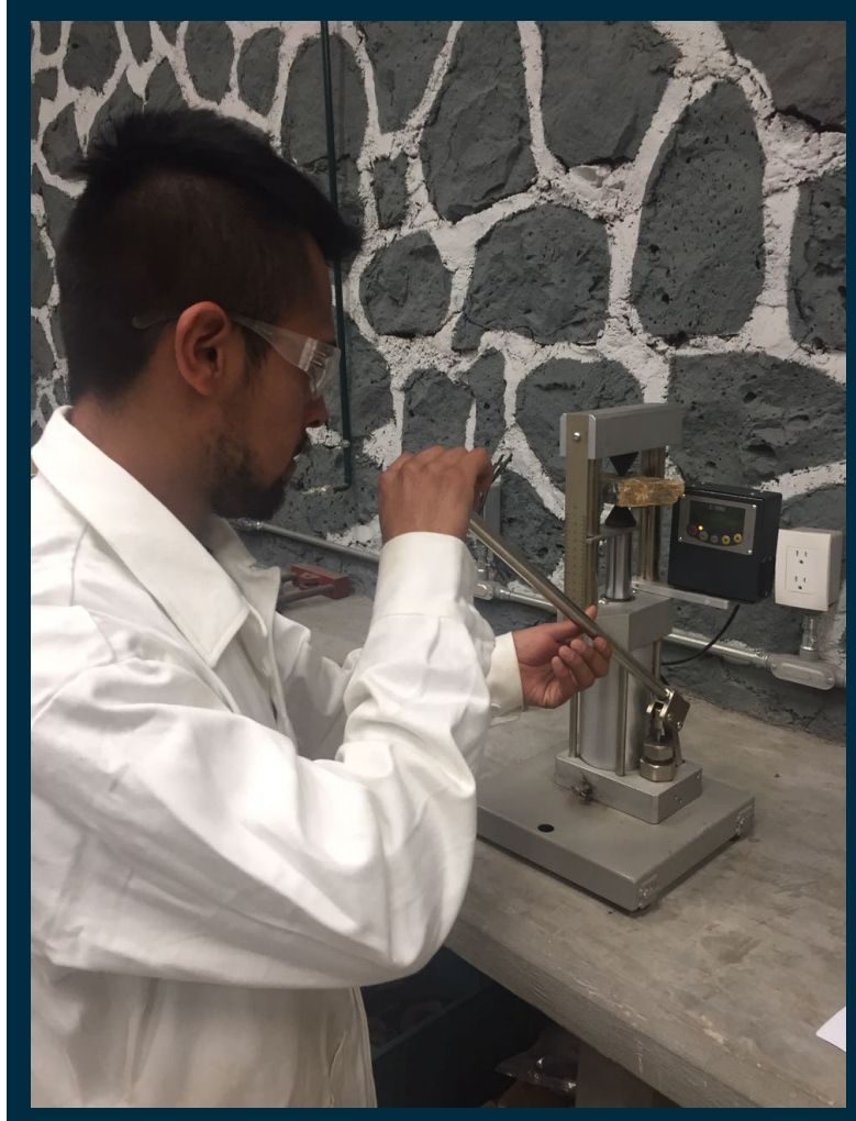
Figura 2.21 Realización del ensayo Franklin.
