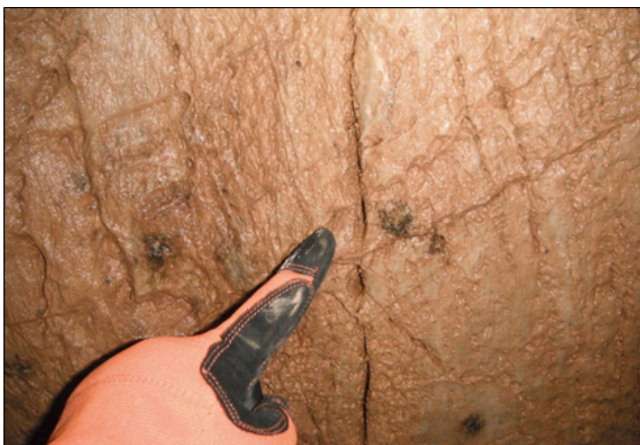
Figura 4.2 Fotografía de una discontinuidad presente en el macizo rocoso.
