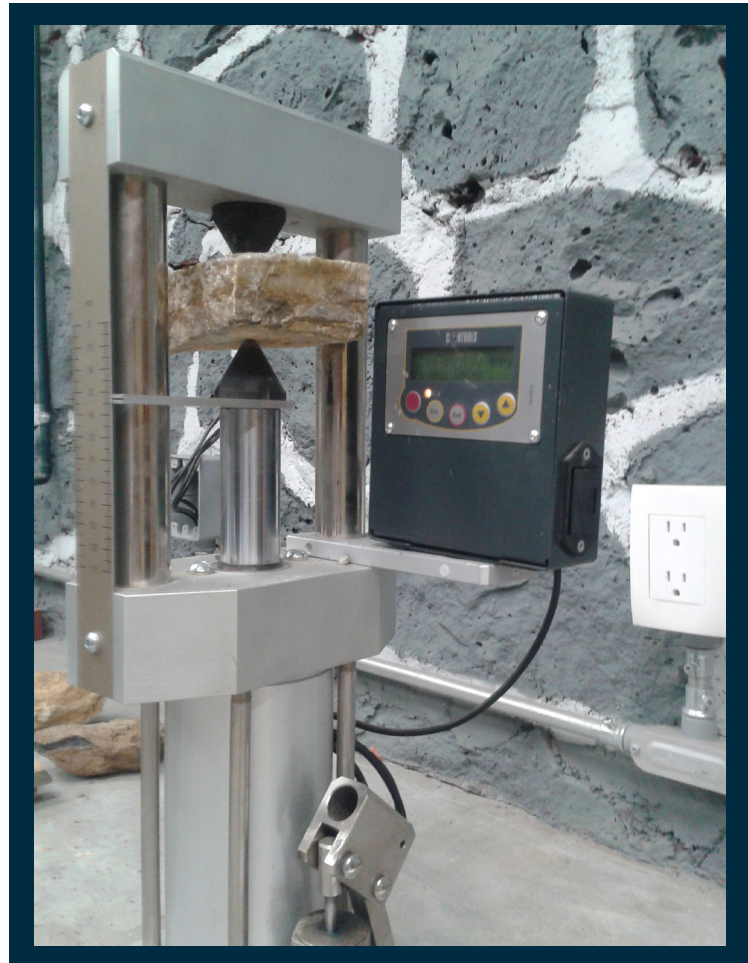
Figura 2.20 Muestra de roca entre las puntas cónicas de la prensa hidráulica.
