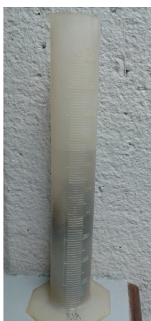
Figura 2.25. Muestra de roca dentro de la probeta con agua.
