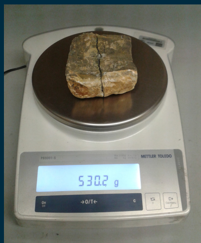
Figura 2.23 Roca sobre la balanza electrónica.
