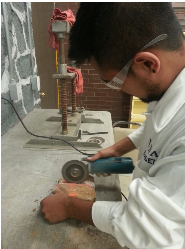
Figura 2.18a Corte de muestras con esmeriladora.
