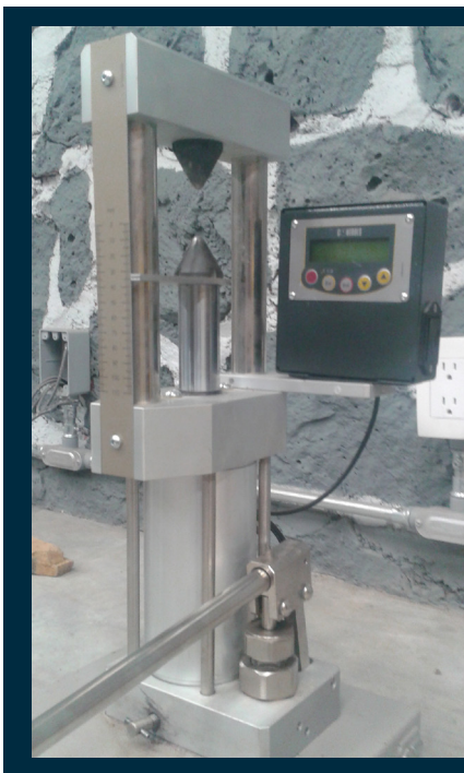
Figura 2.16a. Prensa hidráulica para el ensayo Franklin.
