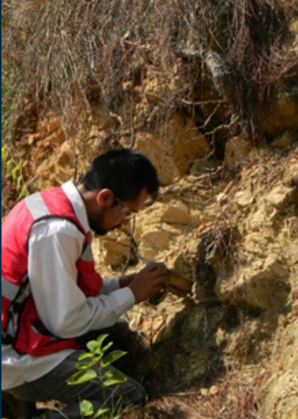
Figura 3.10a Medición de estructuras en areniscas y limolitas.
