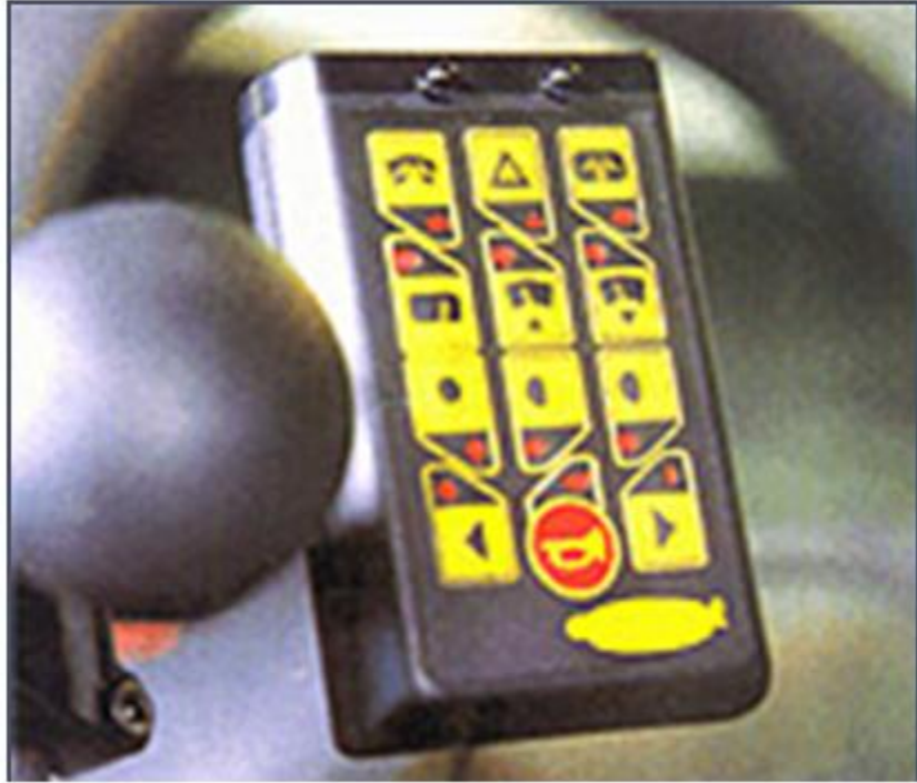
Figura 10. Estos son los botones de las diferentes funciones para el equipamiento de luces y limpiadores. Este tipo de teclados dan más seguridad al conductor.
