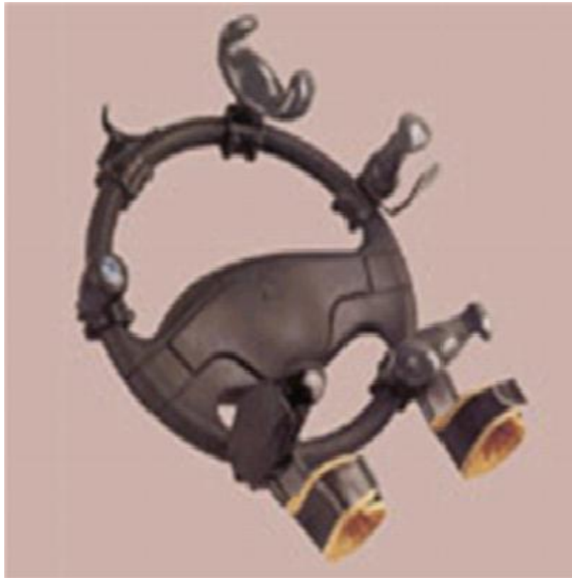
Figura 7. Los diversos tipos de empuñaduras auxiliares en la diversidad de discapacidades. La función es poder sujetar el volante con seguridad.
