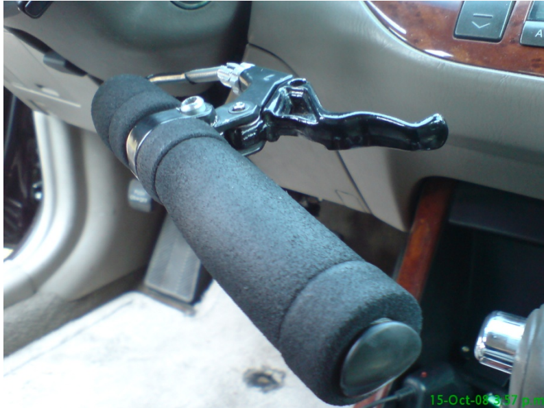
Ilustración 35. Sistema de freno de bicicleta adaptado para acelerar el vehículo
