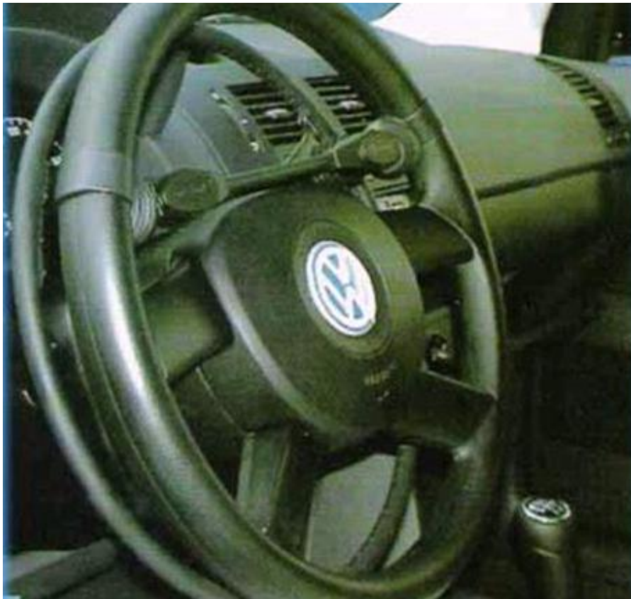
Figura 5. Aro de aceleración montado en la parte posterior al volante. Este sistema cuenta con telemando a otro sistema electrónico que acelera el vehículo.
