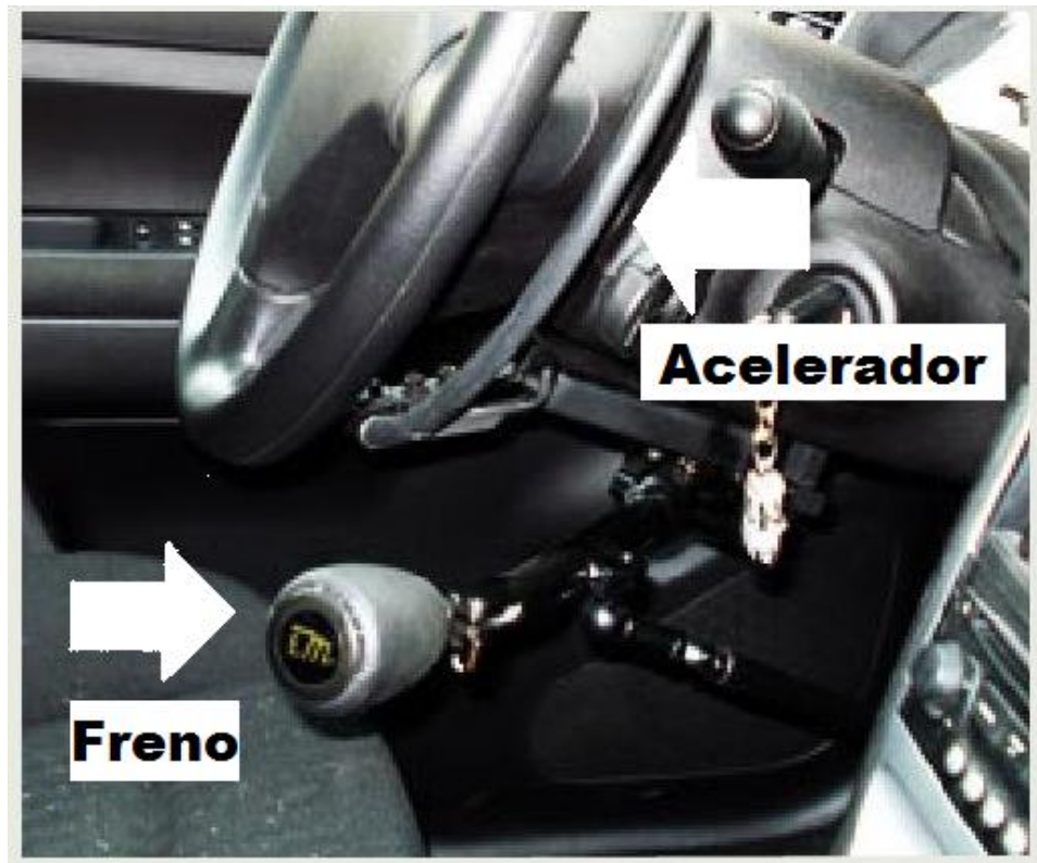
Figura 4. Es una adaptación para el acelerador y el freno.
