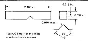
FIG. UG-84 SIMPLE BEAM IMPACT TEST SPECIMENS (CHARPY TYPE TEST)
