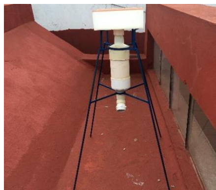
Ilustración 2.1-1 Dispositivo diseñado y utilizado para el análisis preliminar de la calidad del agua de lluvia en Guanajuato. (Arias Hernández et al., 2017)
