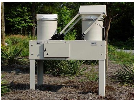
Ilustración 2.1-4 Muestreador automático modelo TE-78-100 utilizado por Lara. Recuperado de http://www.bihec.cn
