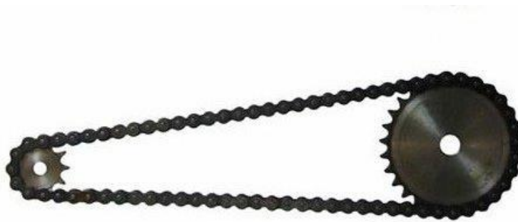
Ilustración 4.2-7 Cadena de transmisión. MecanESO 2005, recuperado de http://concurso.cnice.mec.es/cnice2006/material107/
