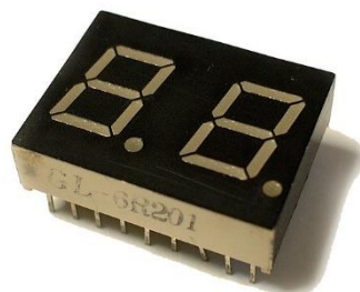
Ilustración 4.4-24 Display led de 2 dígitos. Recuperado en https://commons.wikimedia.org/wiki/File:7_Segment_LED.jpg
