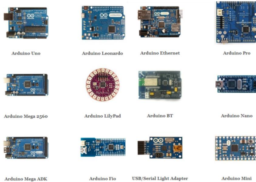
Ilustración 4.4-23 Presentaciones diferentes del microcontrolador Arduino. Recuperado en http://www.minimizedmusicrecords.es/cursos_tutoriales/DIY_arduino/entorno_arduino.html
