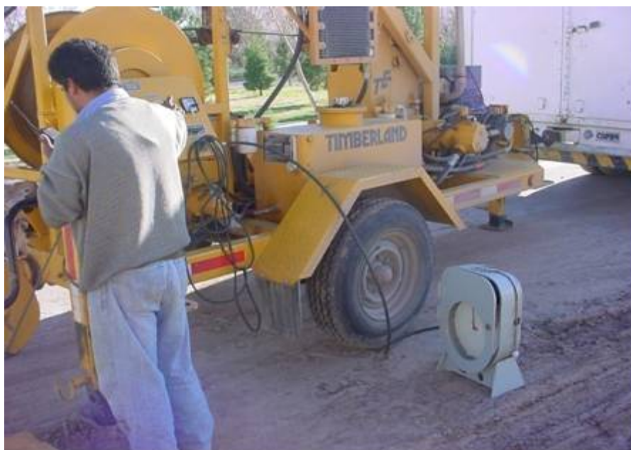
Figura 1-6 Dinamómetro en carrete guía.
