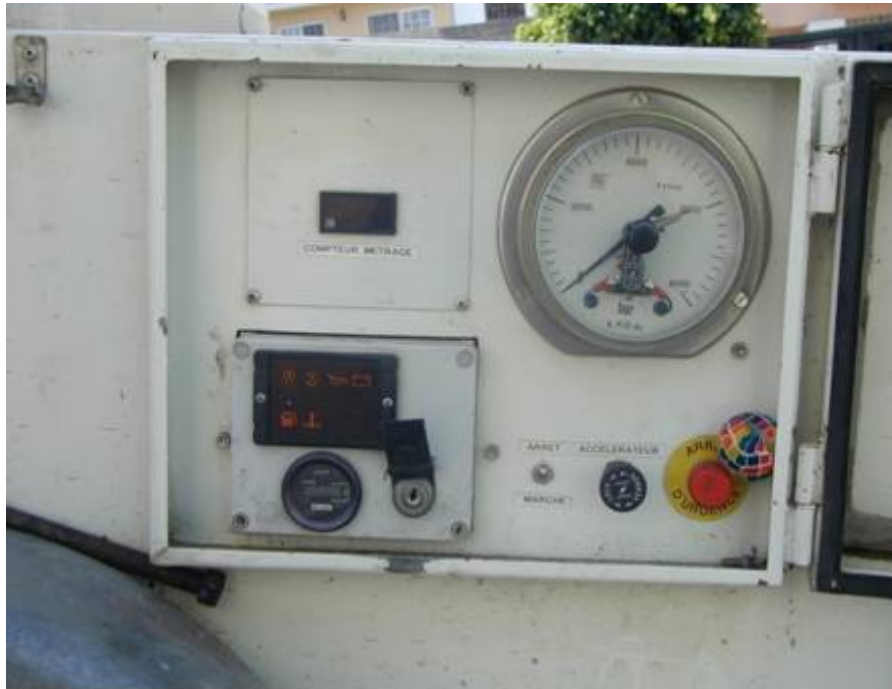
Figura 1-7 Dinamómetro en carrete guía.
