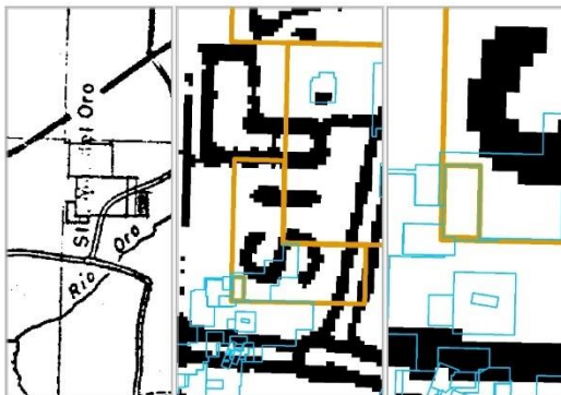
Figura U Ejemplo de georreferencia de Reservas Mineras mediante Lotes Mineros colindantes.
