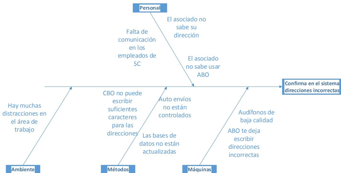
Figura 13 Diagrama causa efecto confirmación de dirección en Sistema (Elaborado por Sebastián Morales)
