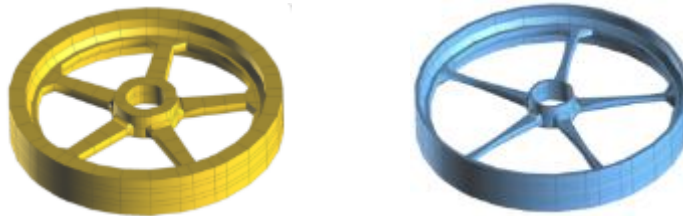
Figura 6. Ejemplo de optimización. A la izquierda se muestra el diseño antes de optimizar y a la derecha después de la optimización.
