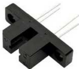
Figura 3.4: Opto-interruptor utilizado para detectar la posición cero
