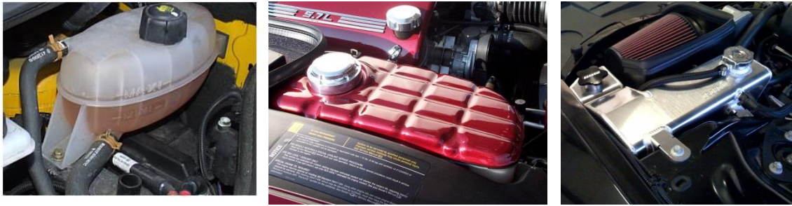
Figura 2.8 Diferentes tanques para refrigerante con múltiples cámaras, a) Tanque en forma de ovoide, b) Tanque con parte superior pintada, c) Tanque metálico (BD Auto Pro, 2015; RPI Designs, 2016; 3rd Strike Performance, 2016).
