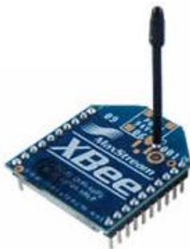
Figura 3.1 – Modem XBee® 802.15.4
