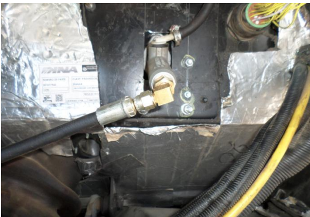
Sistema mandos de embrague servoasistido Kongsberg
