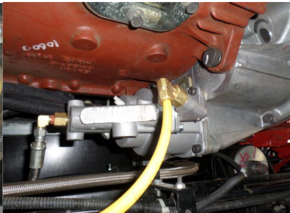
Sistema mandos de embrague servoasistido Kongsberg
