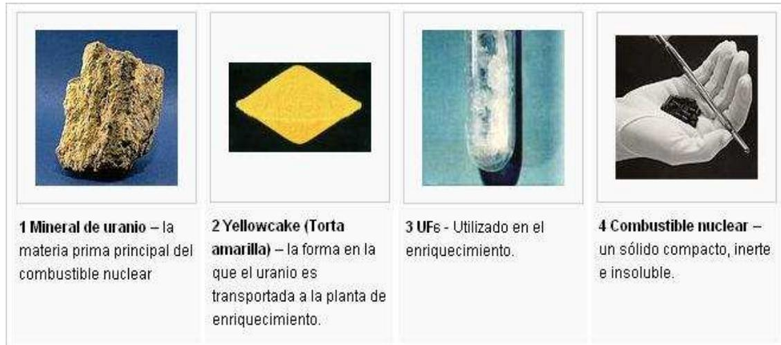
**Figura 1.5 Proceso del combustible nuclear**
