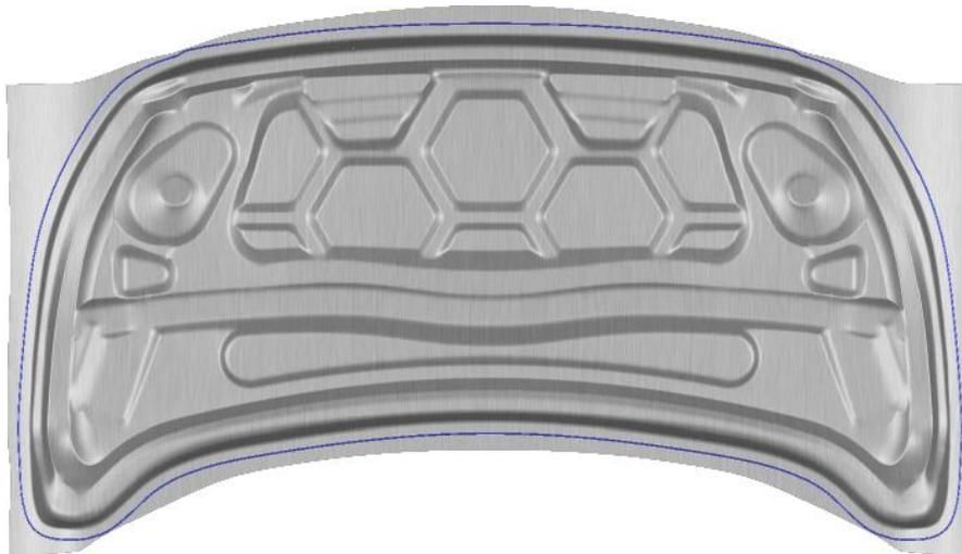
**Imagen 9 Simulación del proceso de estampado del panel del cofre interior**
