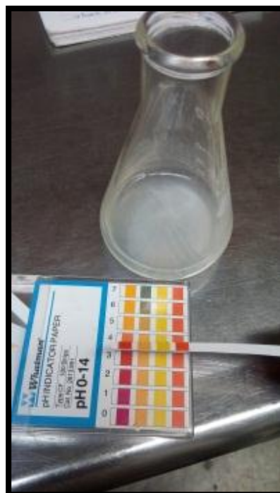
Figura 16. Medición de pH de la solución después de lixiviar.
