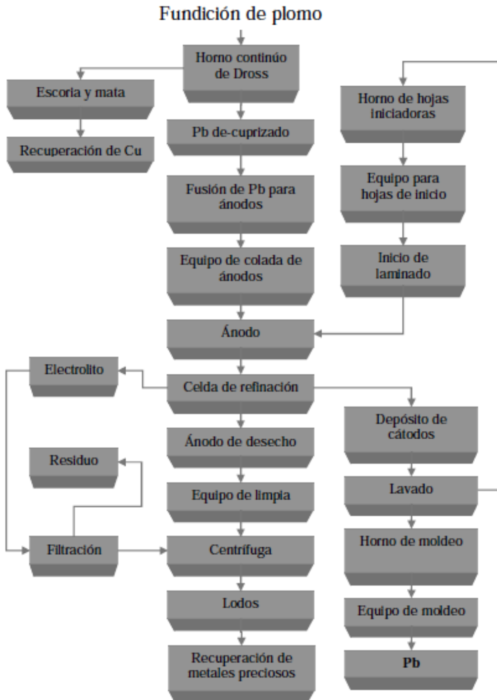
Figura 6. Diagrama de la refinación pirometalúrgica-electrometalúrgica de Pb (González & Peters, 1991).
