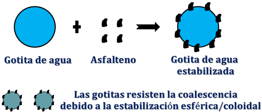
Figura 3.4 Mecanismo de estabilización de la emulsión por agregación de asfaltenos. [13]
