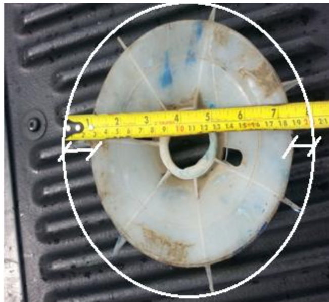
Fig. 27: Desgaste en alabes mayor a 1"
