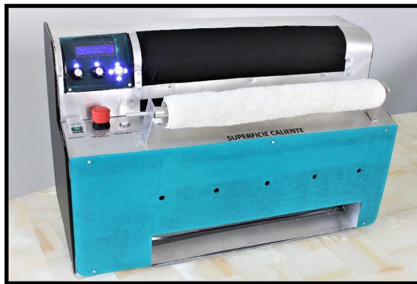
Figura 43 Rodillo de aluminio ubicado al inicio del ciclo que ayuda la toalla a ingresar.
