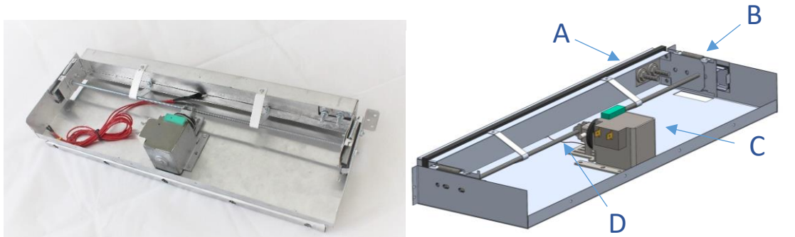
Figura 34 Modelo tridimensional y fotografía del mecanismo para presionar la toalla con las tiras calefactoras. A) Resistencia calefactora, B) Corredera con resortes, C) Solenoide, D) Cable del sensor de Temperatura.
