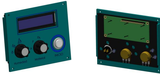
Figura 35 Modelo tridimensional de la interfaz con el usuario incluye: la pantalla LCD, las perillas, el botón de inicio y los LEDs indicadores.
