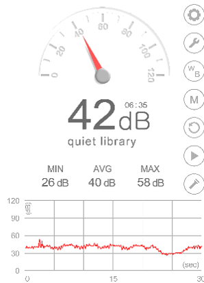
Figura 52 Captura de la aplicación móvil en la que se aprecian los decibeles instantáneos, el promedio, máximos y mínimos. 15
