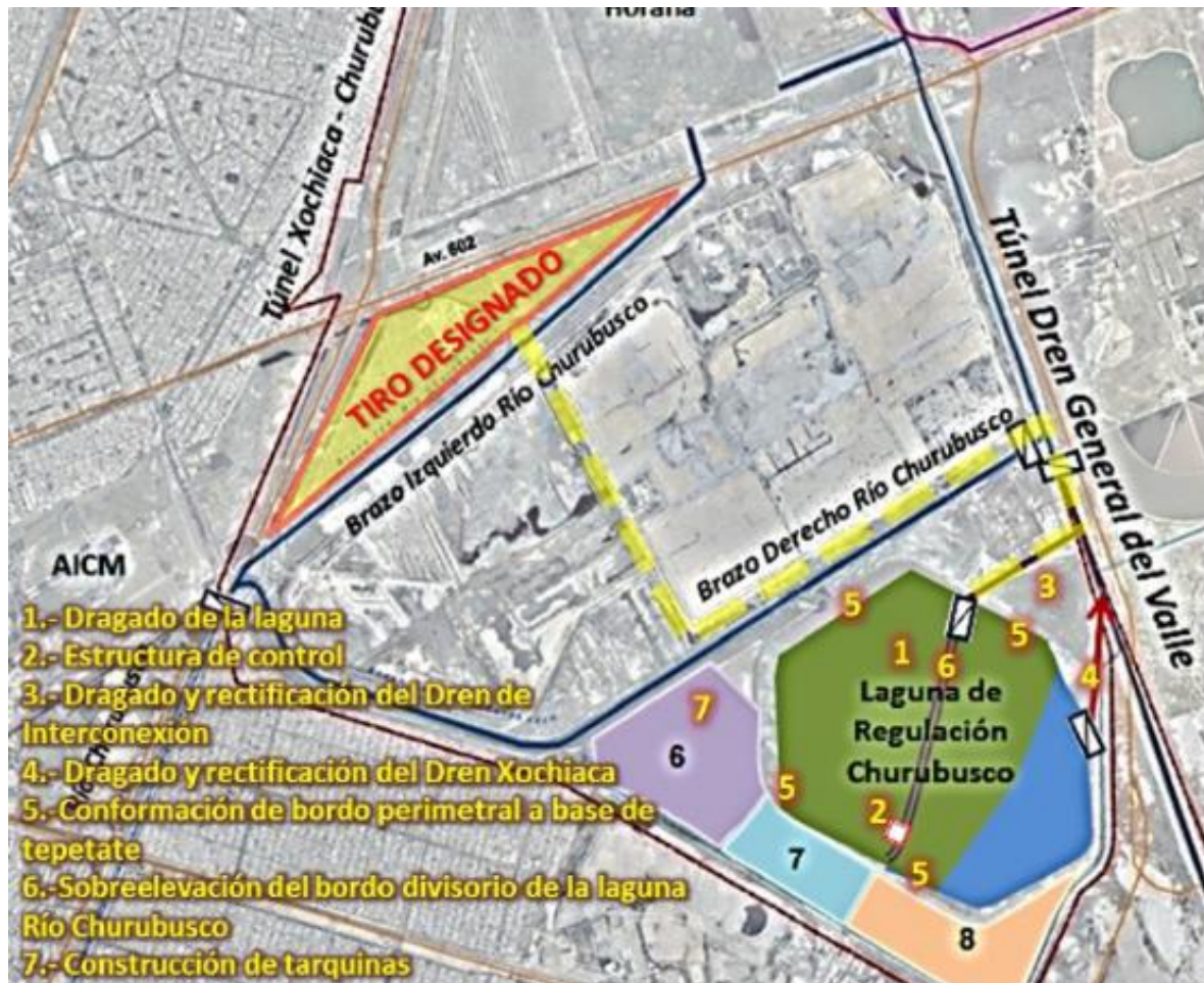
Figura 10. Localización del conjunto de obras complementarias al Dragado de la Laguna Churubusco.
