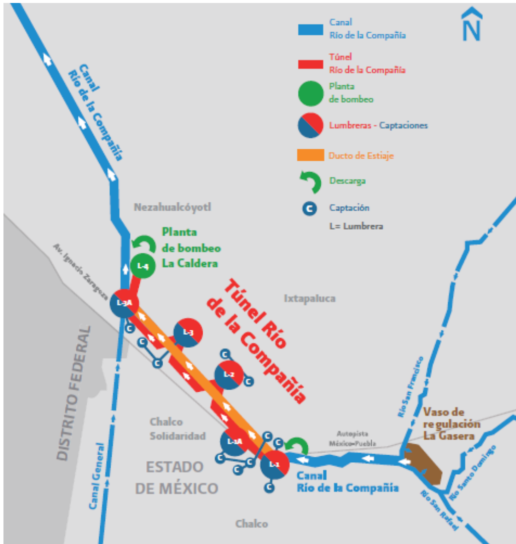
Figura 7. Sistema de obras de drenaje del oriente-sur del Valle de México.
