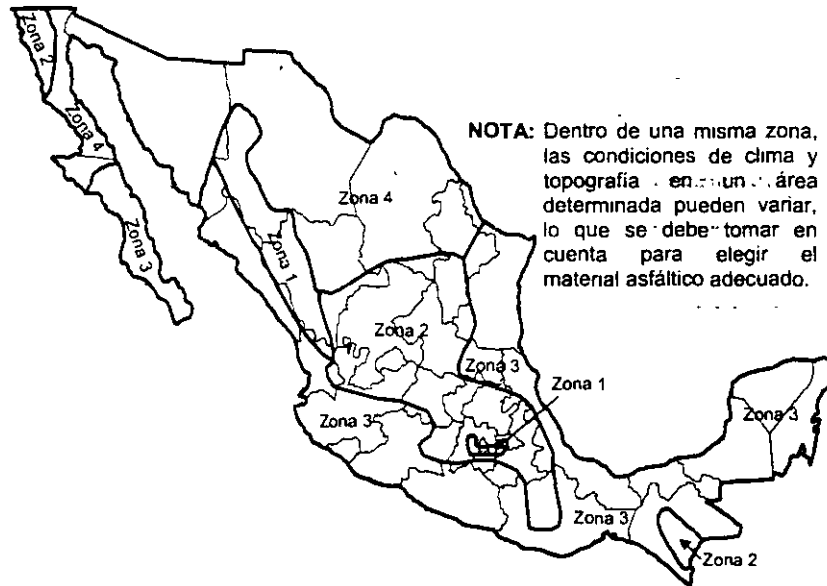
FIGURA 1.- Regiones geográficas para la utilización de asfaltos clasificados según su viscosidad dinámica a 60°C. (Ver Tabla 2)
