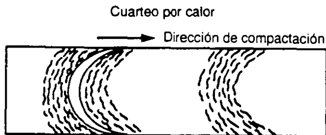
Figura 6.4 - Cuarteo por Calor (Vista de Planta).
