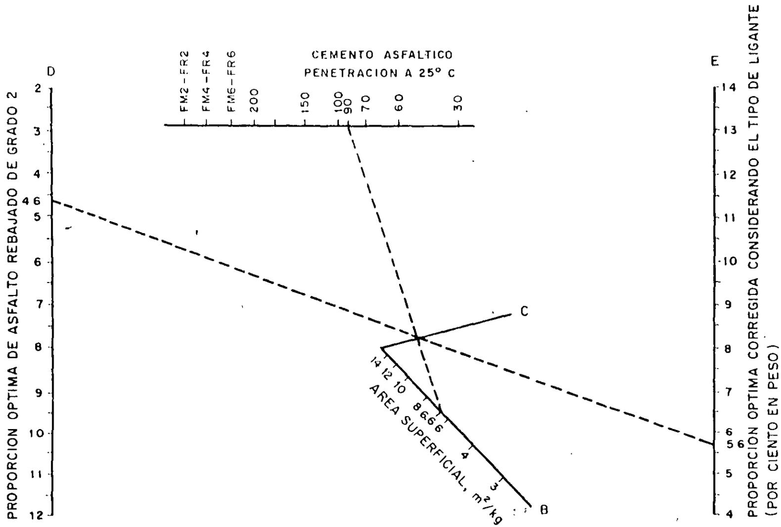
FIGURA NUM. 6 GRAFICA PARA CORREGIR LA PROPORCION OPTIMA DE ASFALTO - CONSIDERANDO LA CONSISTENCIA DEL TIPO DE LIGANTE SELECCIONADO.
