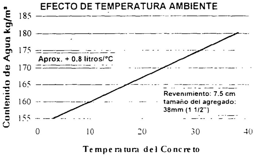
La cantidad necesaria de agua en una mezcla de concreto aumenta con el incremento en la temperatura del concreto
