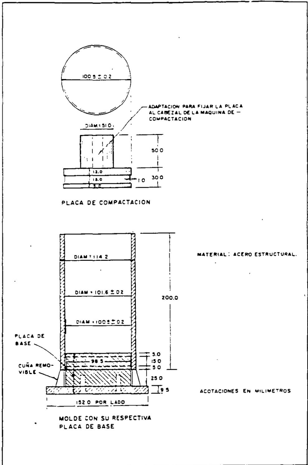
FIGURA NUM.- 7 MOLDE Y PLACA DE COMPACTACION PARA LA PRUEBA DE COMPRESION SIN CONFINAR EN MEZCLAS ASFALTICAS.
