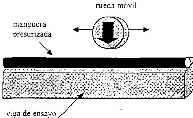
**Figura I-3. Principio del Ensayo de la Rueda cargada de Georgia**
