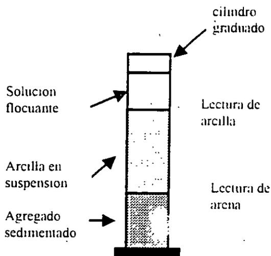
**Figura III-2. Ensayo de equivalente de arena**
