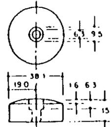
(14) ADAPTADOR DEL CABEZAL
