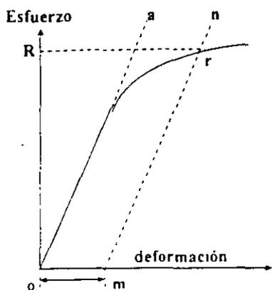
Fig. 20 diagrama esfuerzo-deformacion para la determinacion del limite de fluencia por el metodo de la deformacion permanente
