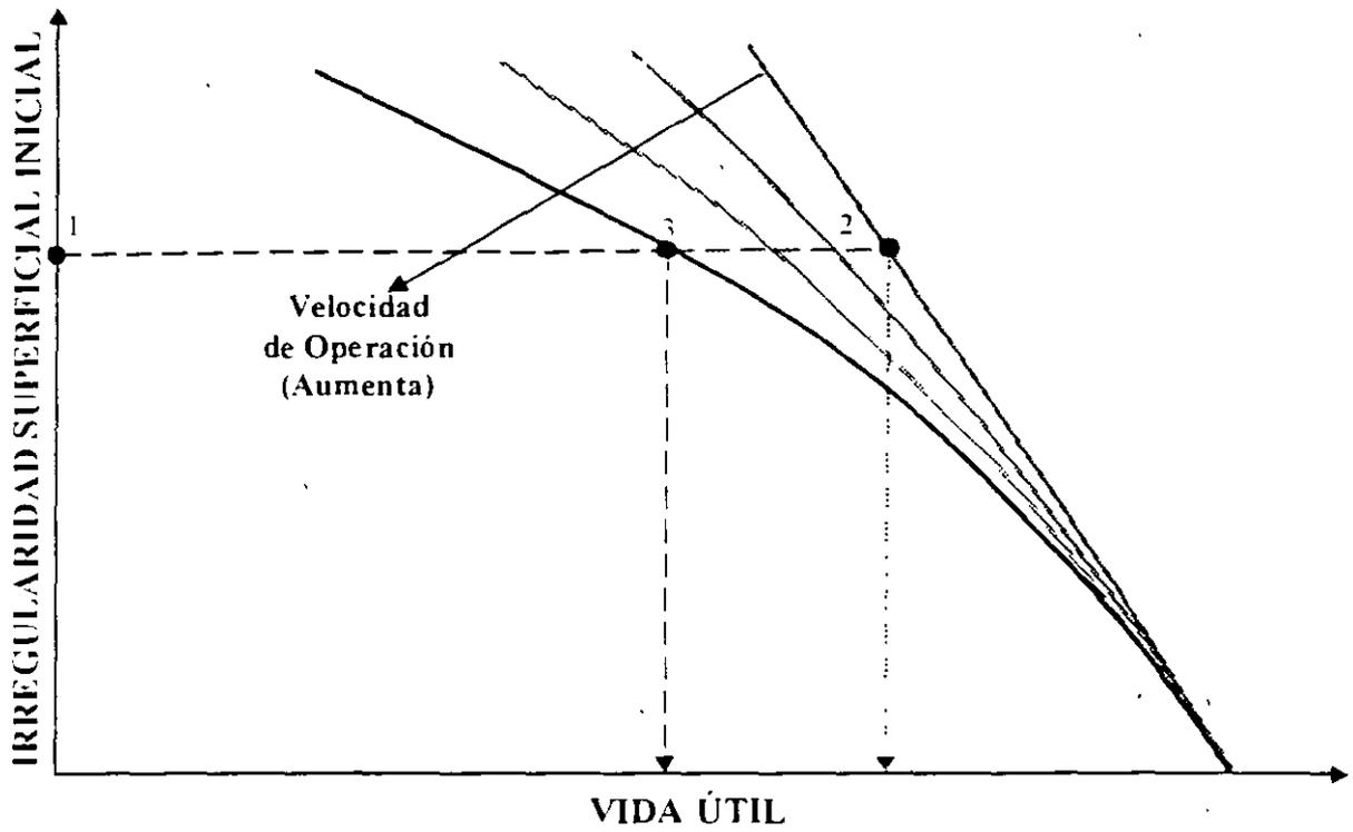
**Fig. 4. EFECTO DE LA VELOCIDAD DE OPERACIÓN
