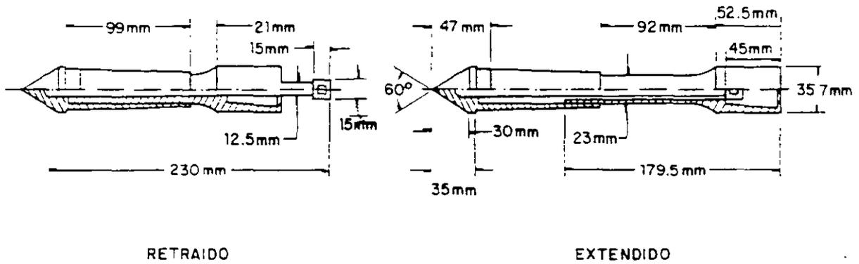
FIG 1 - EJEMPLO DE UN PENETROMETRO MECANICO DE PUNTA
