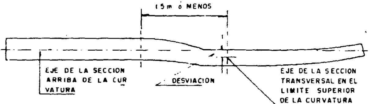
CASO 3. - LOS EJES DE LA SECCION ARRIBA DE LA CURVATURA NO SON PARALELOS NI COLINEALES CON EL EJE ABAJO DE LA CURVATURA
