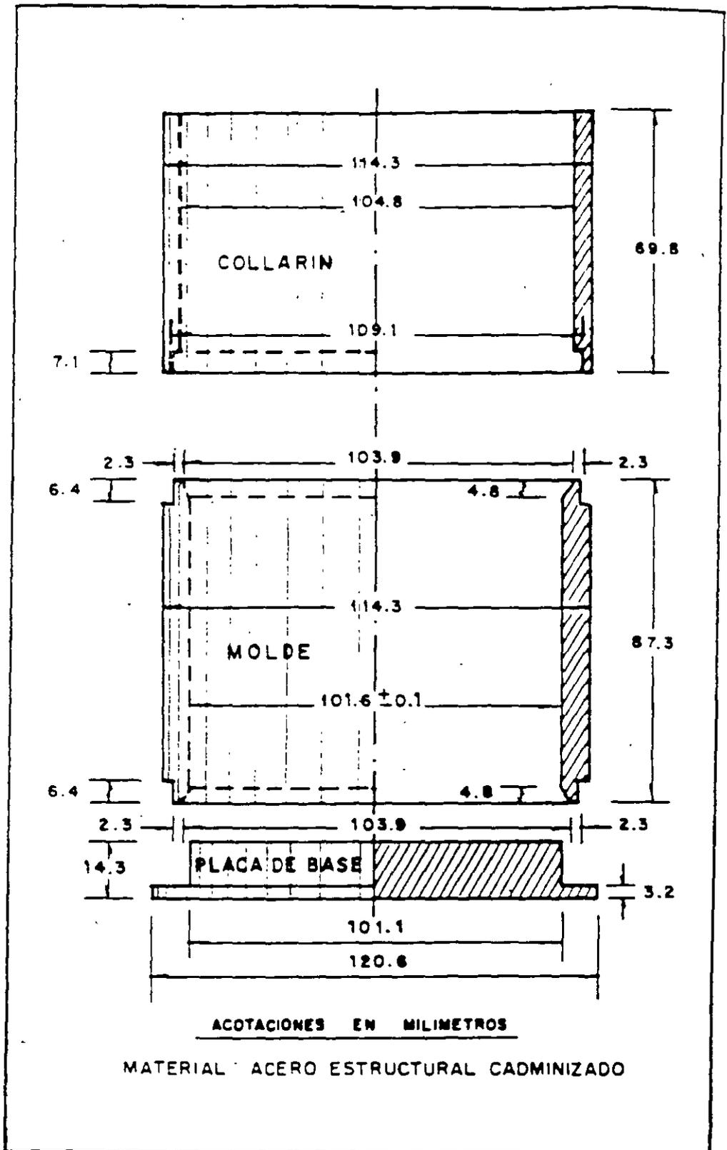
**FIGURA NUM. 8 MOLDE DE COMPACTACION PARA LA PRUEBA DE MARSHALL.**
