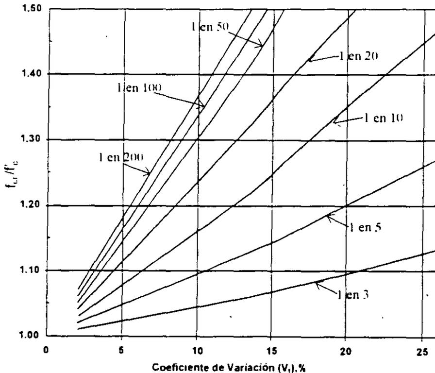
$$\frac{f_{cr}}{f_c} = \frac{\text{Resistencia Media Requerida}}{\text{Resistencia de Proyecto}}$$
