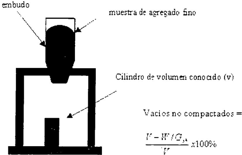
Figura III-1. Aparato para medir la angularidad del agregado fino
