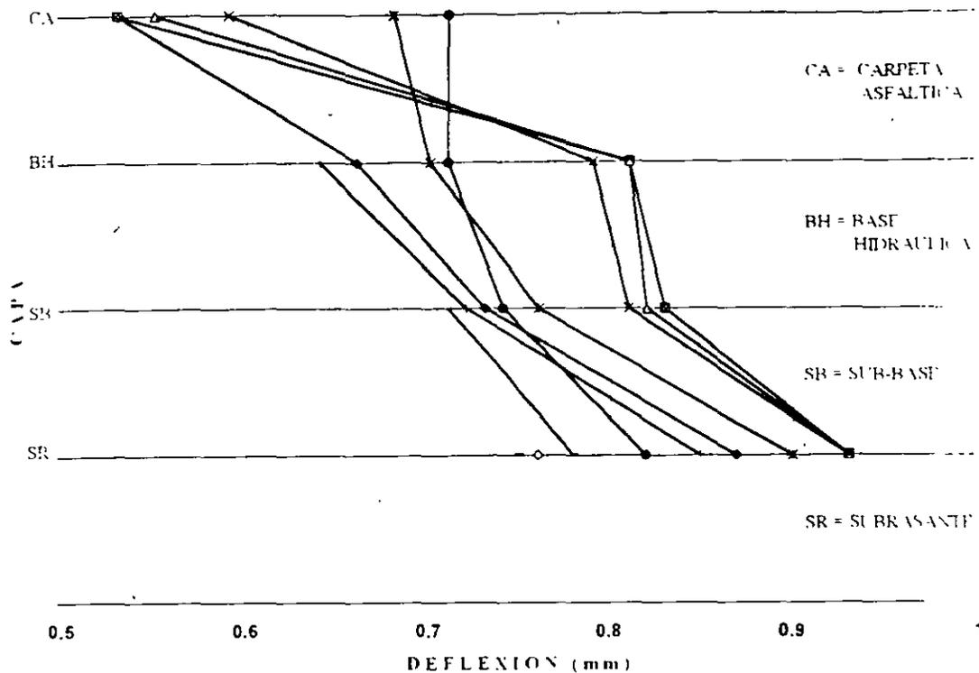
**Fig. 6. COMPARACIÓN DE EQUIPOS NO DESTRUCTIVOS**
