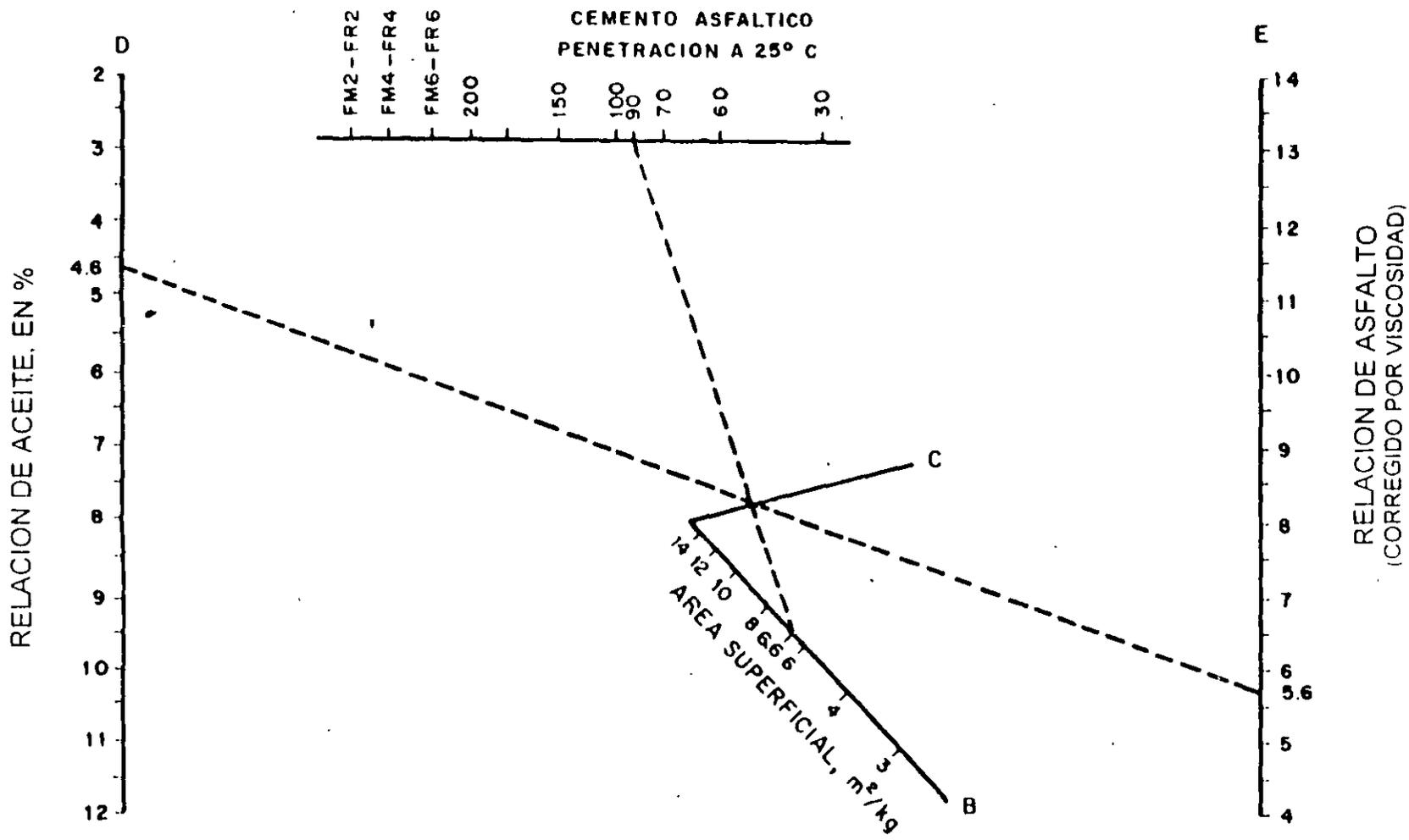
FIGURA NUM. 6 GRAFICA PARA CORREGIR LA PROPORCION OPTIMA DE ASFALTO-
