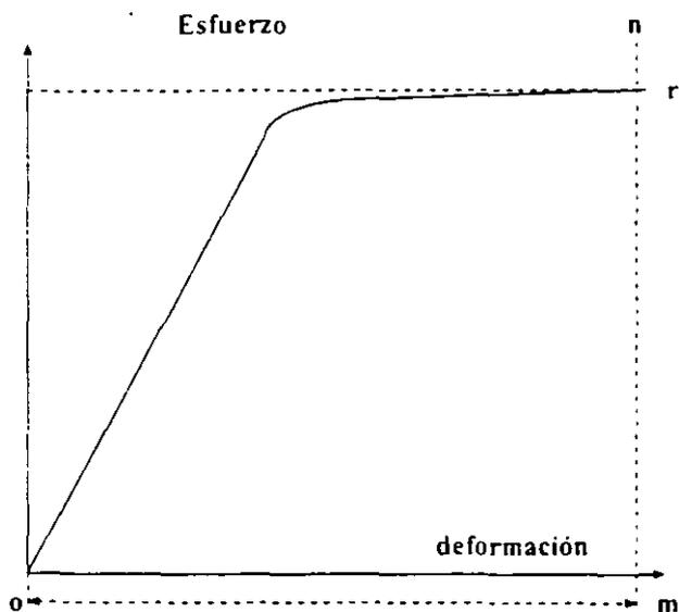
Fig. 22. diagrama esfuerzo-deformación mostrando el limite de fluencia o el limite elástico aparente por el método de alargamiento bajo carga.
