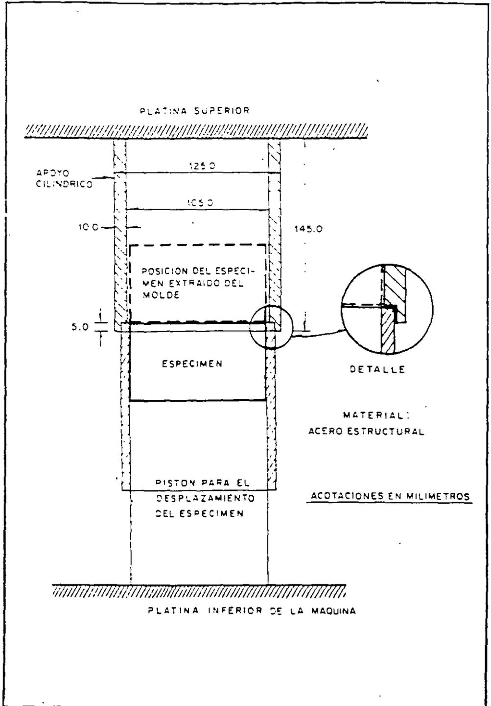
**FIGURANUM. 12 APOYO CILINDRICO MONTADO, PARA SACAR ESPECIMENES DEL MOLDE.**
