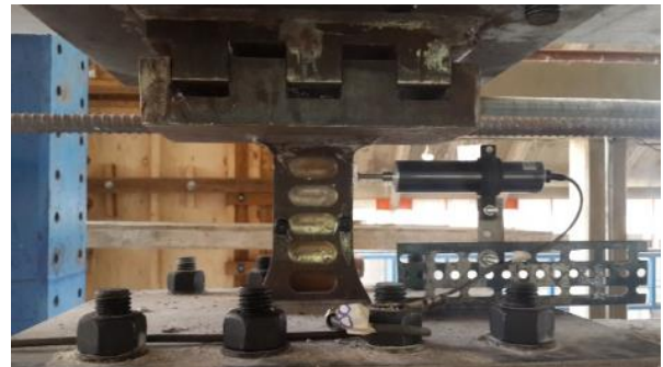
Fig. 2.9 Colocación de transductor 8
