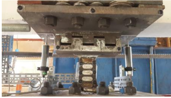
Fig. 2.10 Colocación de transductores 5 y 6
