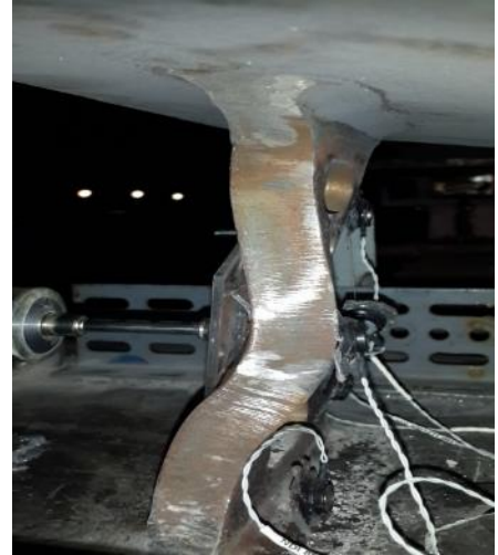
Fig. 2.22 Torsión en el alma del dissipador
