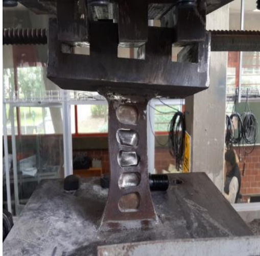
Fig. 2.21 Esfuerzo cortante en el alma del dissipador
