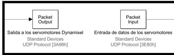
Figura 71.- Bloque de envío y recepción de paquetes UDP a la placa arduino, para el control y retroalimentación de los servomotores Dynamixel
