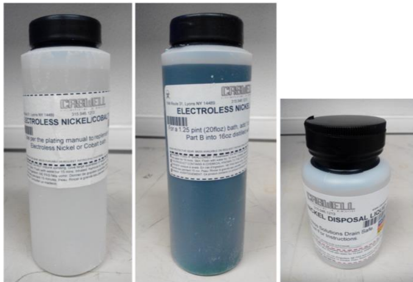
Figura 4.17. Sustancias A, B y C para crear la solución para depositar de níquel.
