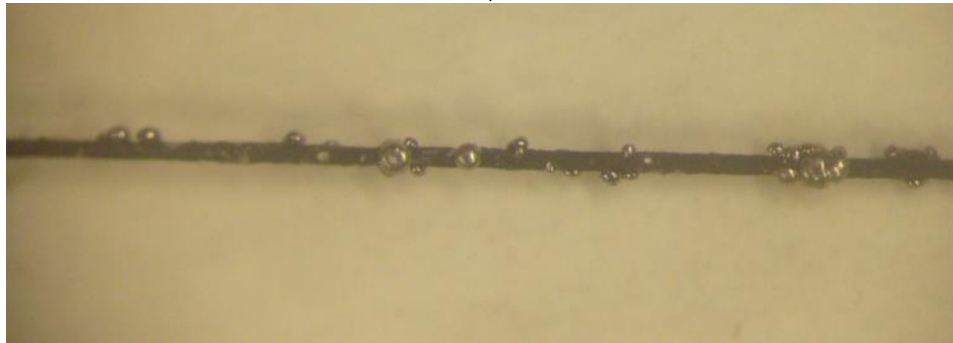
Figura 4.20. Fibra óptica 180 \mu m de diámetro después del niquelado a) un extremo, b) parte media.
