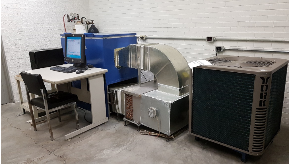
Fig.4.8 Máquina de ensayos acelerados de corrosión atmosférica ubicada en el área de corrosión de la UDIATEM Edificio "O", Anexo de Ingeniería
