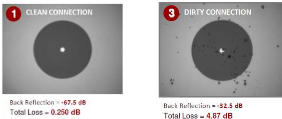
Figura 3.13 Fibra óptica limpia y contaminada.
