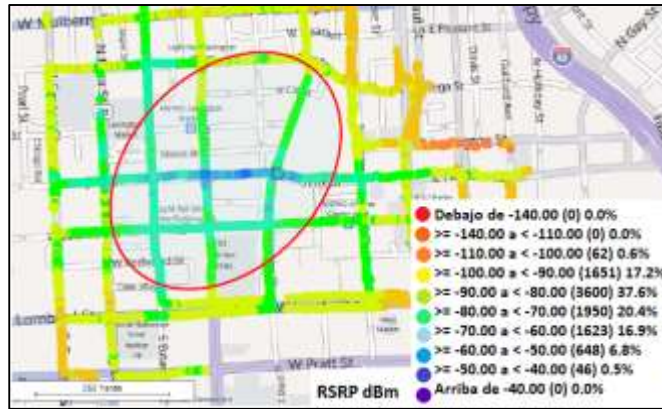
Figura 3.5 Ejemplo de mapa de RSRP con scanner PCTEL.
