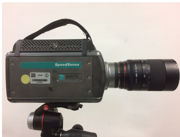
Figura 2.5: Cámara rápida marca Dantec empleada en la grabación de perlas de mezcal
