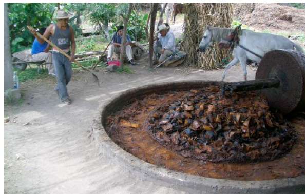
Figura 1.9: Molienda de piñas cocidas de maguey en un horno de piedra tradicional jalado por un caballo, tomada de [15].
