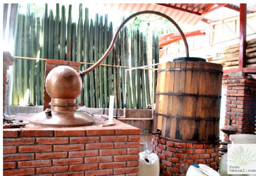
Figura 1.11: Alambique u olla de destilación de cobre de una casa mezcalera, tomada de [17].
