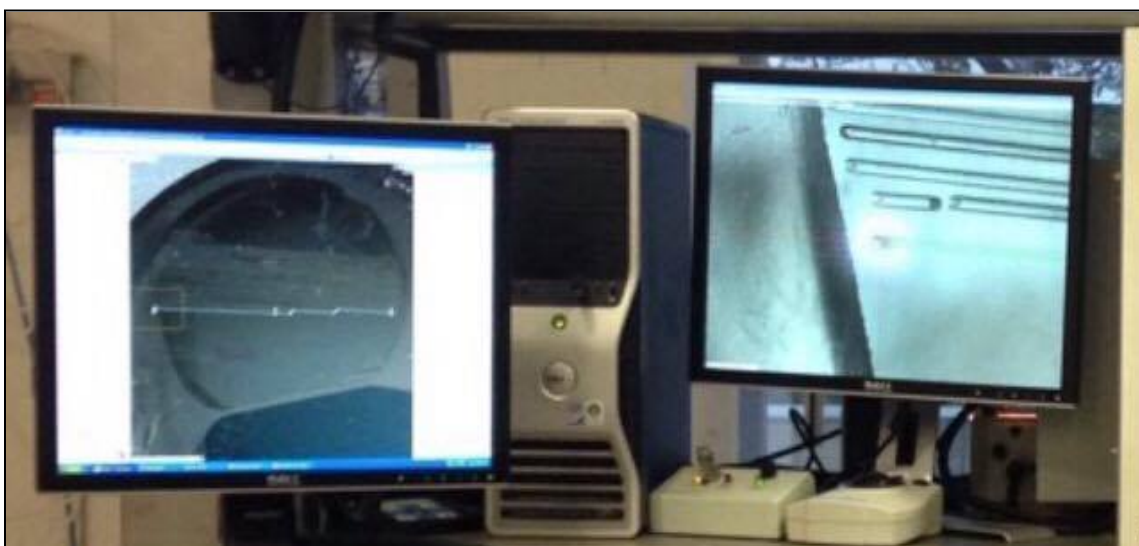
Figura 4.4. Monitoreo de las pruebas para determinación de las condiciones de análisis. En la pantalla de la izquierda pueden observarse la línea continua de ablación a lo largo del cristal analizado, en la pantalla de la derecha pueden observarse las distintas líneas de ablación continuas realizadas en el cristal.
