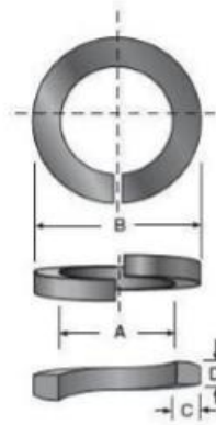
Figura 1. Arandelas elásticas de seguridad o rondanas de presión tipo Grower.
