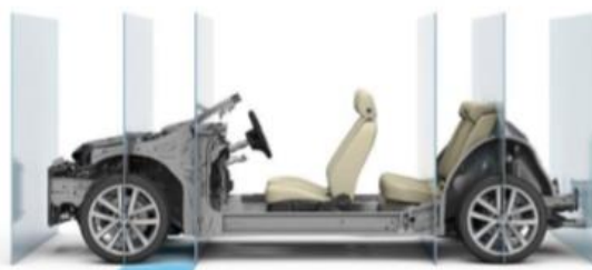
Figura 3. Es común en la industria automotriz, la estandarización de la plataforma modular transversal, se utiliza la misma plataforma para distintos modelos de vehículos de la misma o similar categoría, por ejemplo, en Volkswagen, el modelo Vento y Jetta tienen plataformas iguales con detalles superficiales diferentes, y así sucede con modelos de categorías similares, pero de diferente marca aparentemente, pero pertenecientes a grupo Volkswagen, por ejemplo: categorías
