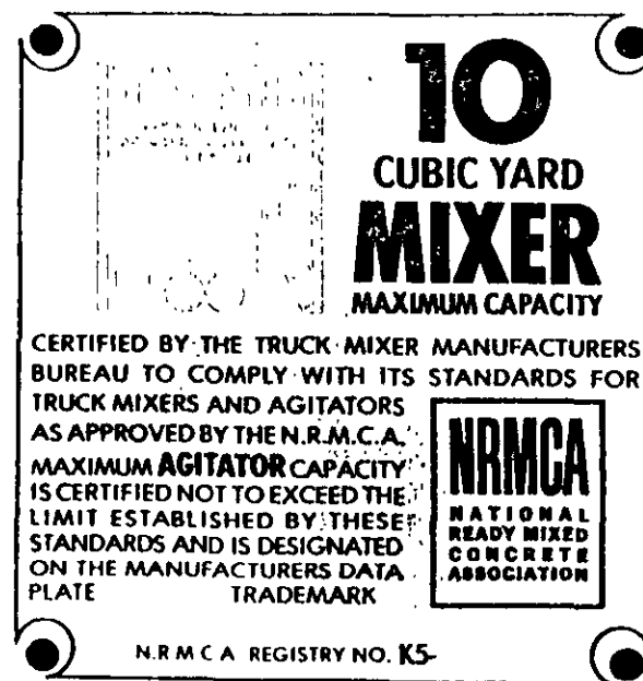
Fig. 7-6—En un camión-hormigonera no se debe amasar ni transportar una mezcla por encima de la capacidad indicada en su placa de clasificación. Cuando sólo se opera como agitador si puede transportarse una cantidad mayor.
