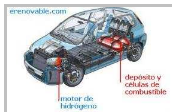
Figura 3.6- Esquema básico de un vehículo equipado con celdas de combustible (IP, 2008)
