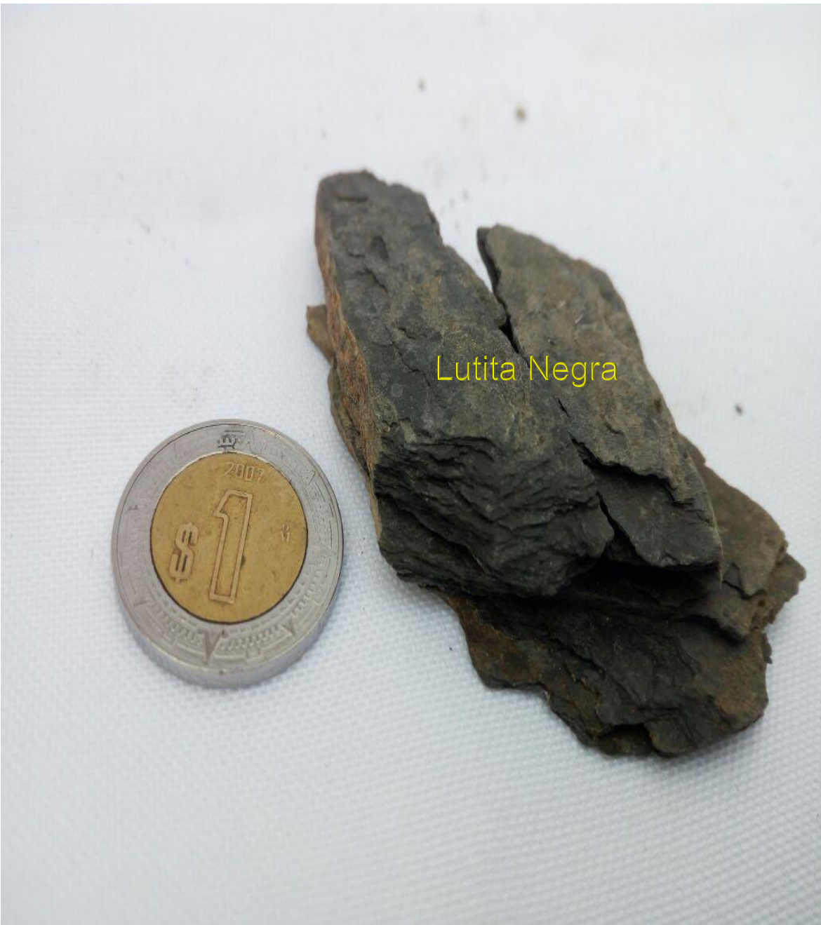
FIG. 17 Muestra 2: Roca integrada de capas de Lutitas Negras con presencia de Limolita en la Cima.
