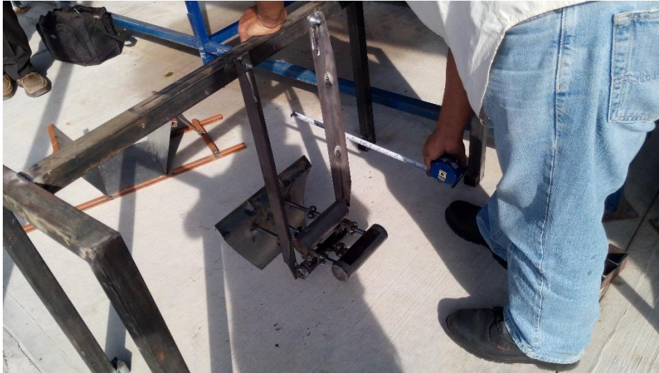
Figura 39. Nivelación de compuerta con marco de acero en modelo del túnel el Tecorito ubicado en laboratorio Enzo Levi
