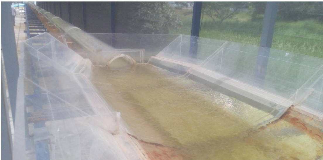
Figura 26. Vista del túnel aguas abajo con un gasto de 16.68 l/s equivalente en prototipo a 104.36 m 3 /s
