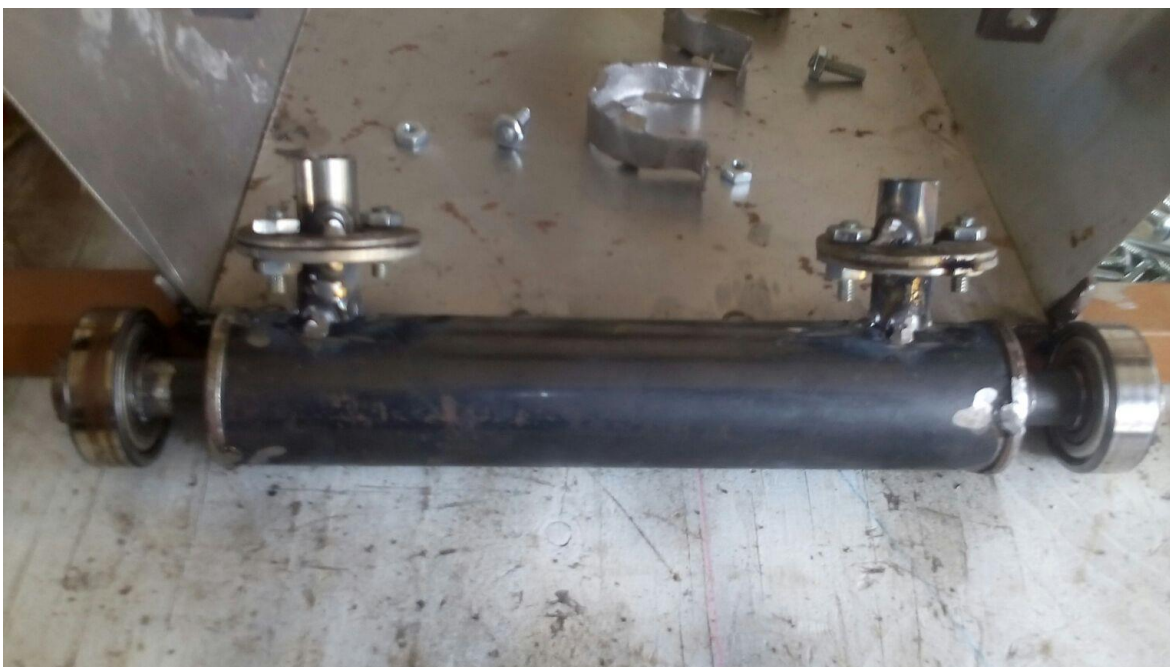
Figura 20. Eje central de la compuerta AMIL
