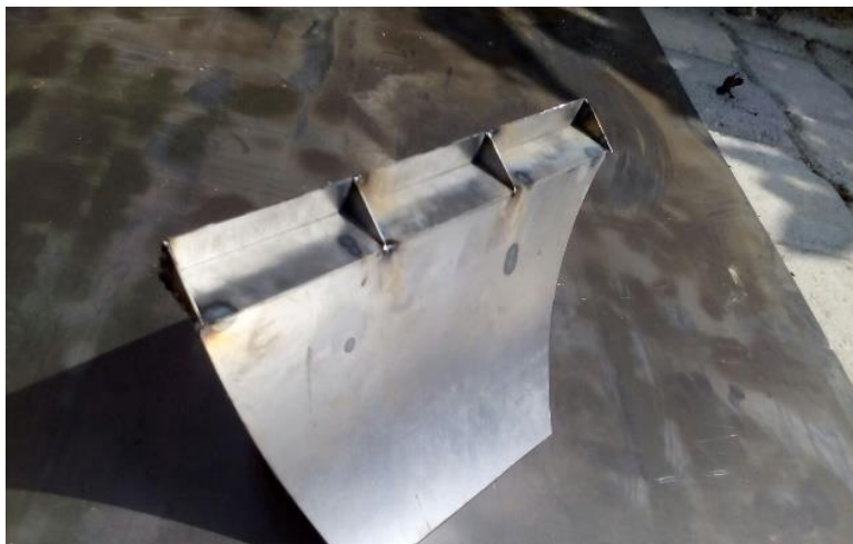
Figura 18. Placa frontal de la compuerta con un radio de diseño de 19.7 cm
