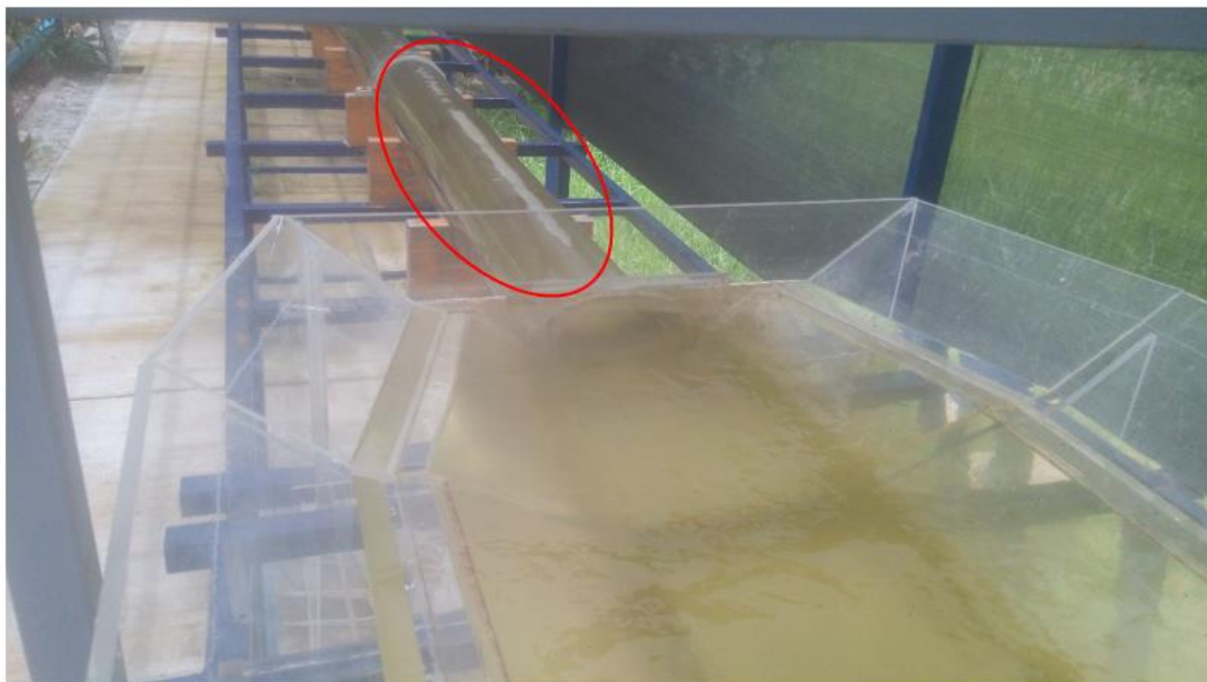
Figura 35. Imágenes con burbuja de aire atrapado dentro del túnel
