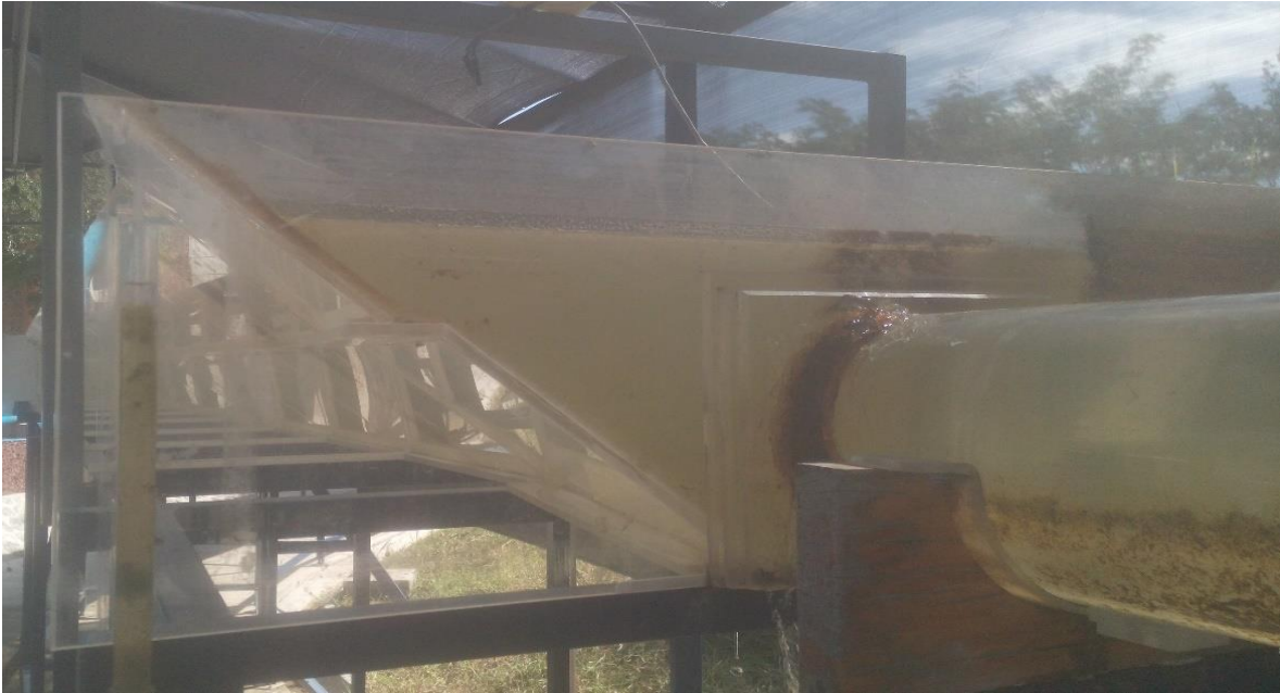
Figura 32. Profundidad a la entrada del túnel = 26.50 cm
