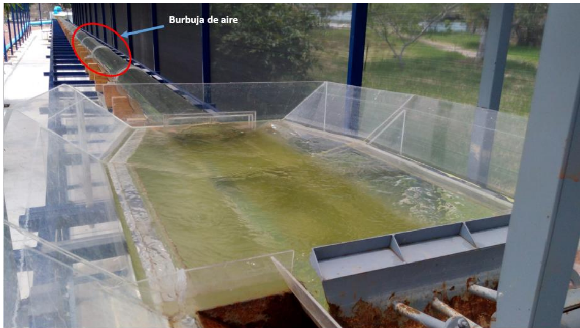
Figura 49. Se observa que la burbuja de aire se encuentra más alejada de la salida del túnel.
