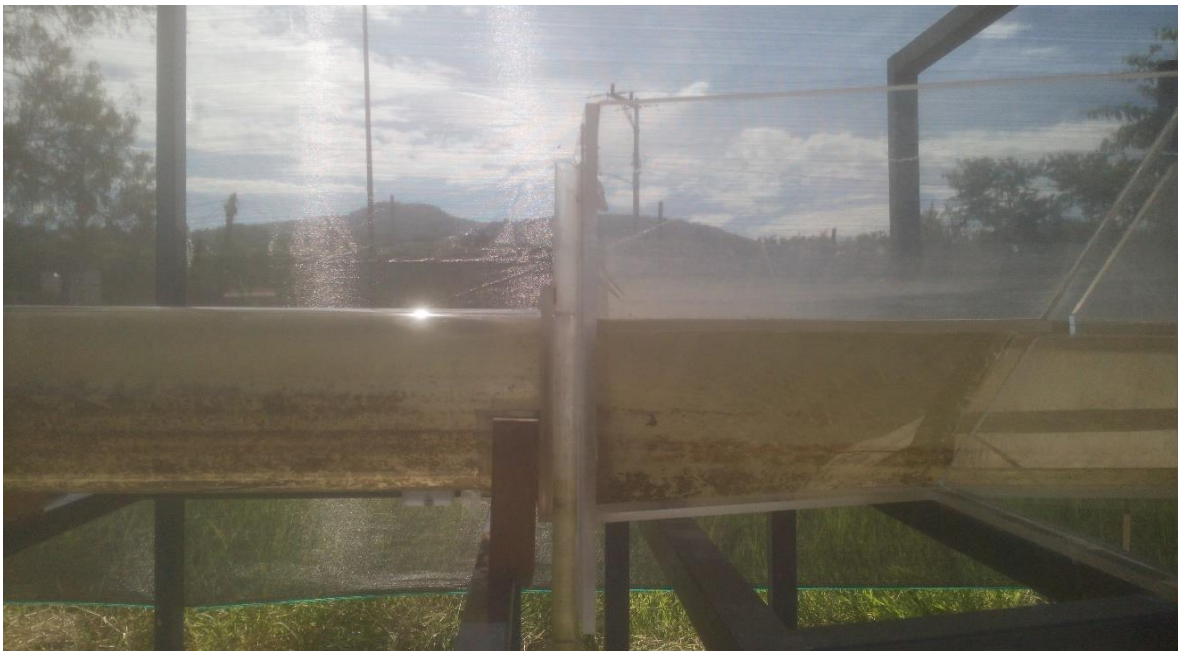
Figura 31. Profundidad a la salida del túnel = 19.00 cm
