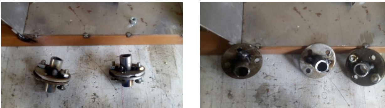
Figura 19. Bridas para uniones de brazos frontales y posteriores
