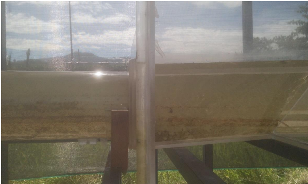
Figura 33 Profundidad a la salida del túnel = 20.60 cm
