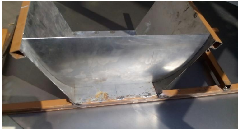
Figura 16. Placa frontal de la compuerta AMIL con un radio de 19.7 cm
