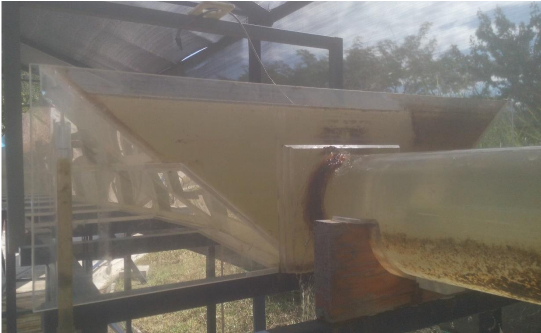
Figura 34. Profundidad a la salida del túnel = 30.00 cm
