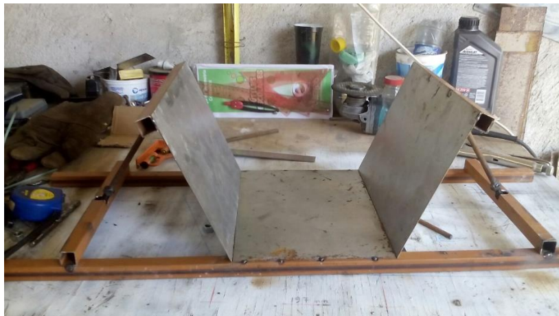
Figura 15 Placas de solera para compuerta AMIL
