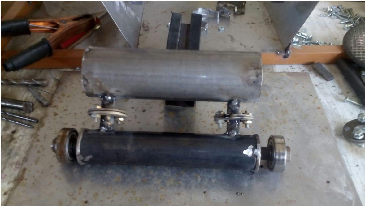
Figura 21. Unión de eje central con contrapeso central
