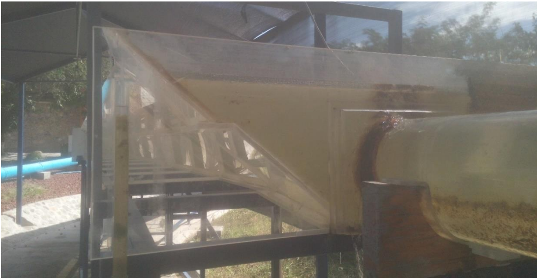
Figura 25. Carga aguas arriba del túnel de 8.70 cm, presurización con gasto de 16.68 l/s equivalente en prototipo a 104.36 m 3 /s
