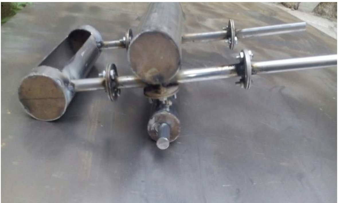
Figura 22. Unión de contrapeso trasero al contrapeso central y eje central de la compuerta AMIL.
