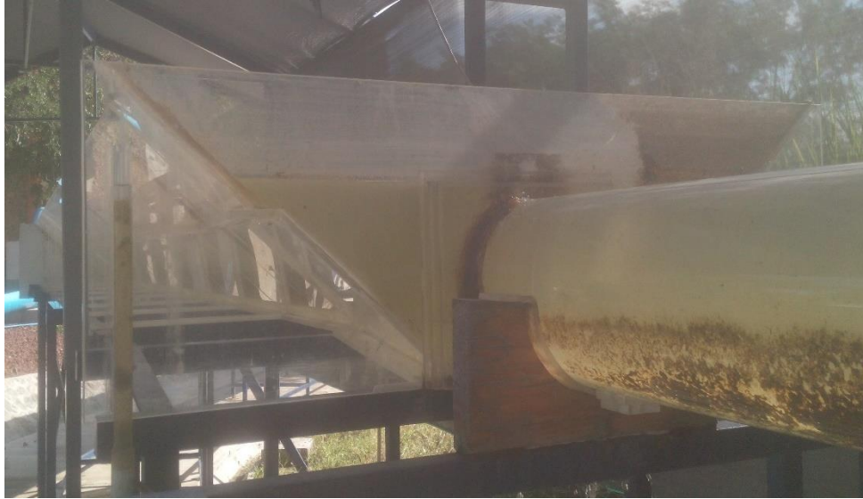
Figura 28. Profundidad a la entrada del túnel = 22.50 cm
