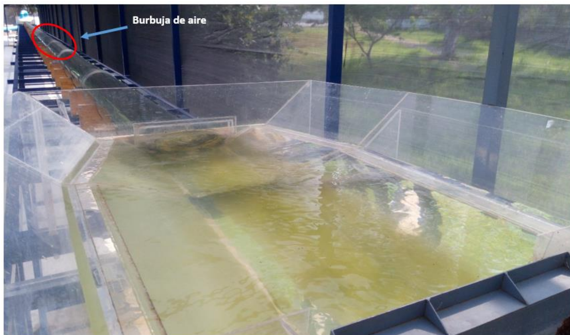
Figura 50. La burbuja de aire se va expulsando gradualmente de aguas abajo hacia aguas arriba.
