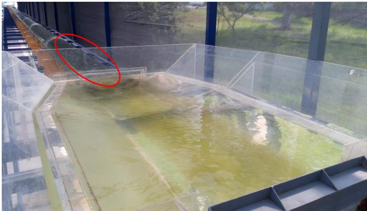
Figura 47. Canal con la compuerta AMIL instalada a la salida del túnel, con ausencia de aire atrapado.
