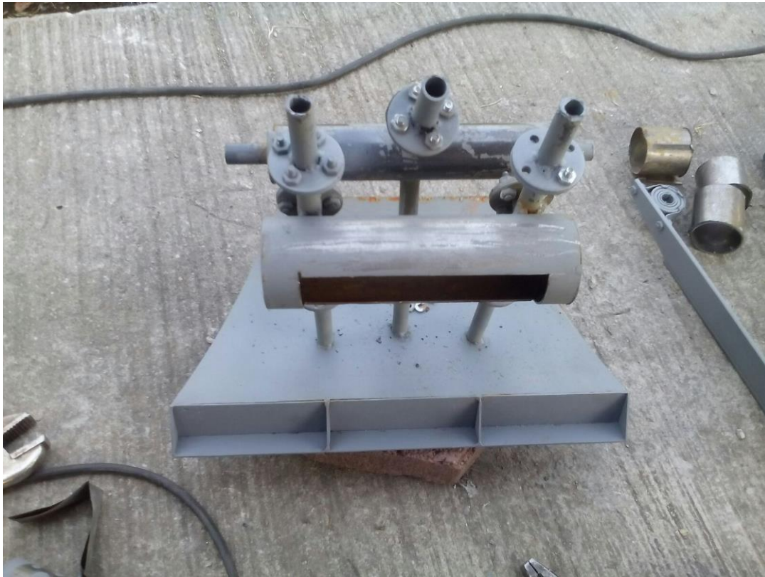
Figura 23. Unión de parte trasera de la compuerta a la placa frontal
