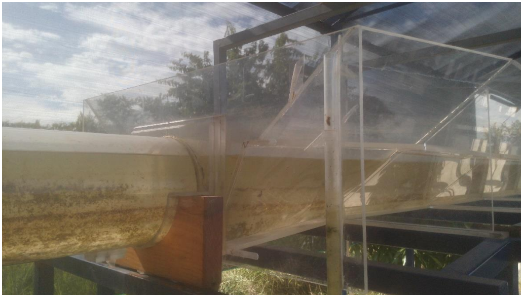
Figura 29. Profundidad a la salida del túnel = 16.30 cm
