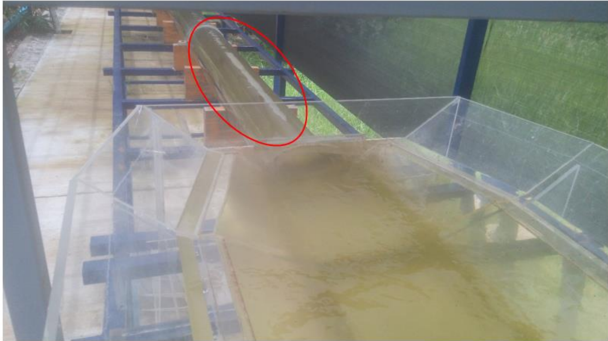
Figura 46. Canal sin compuerta, con presencia de aire atrapado dentro del túnel.
