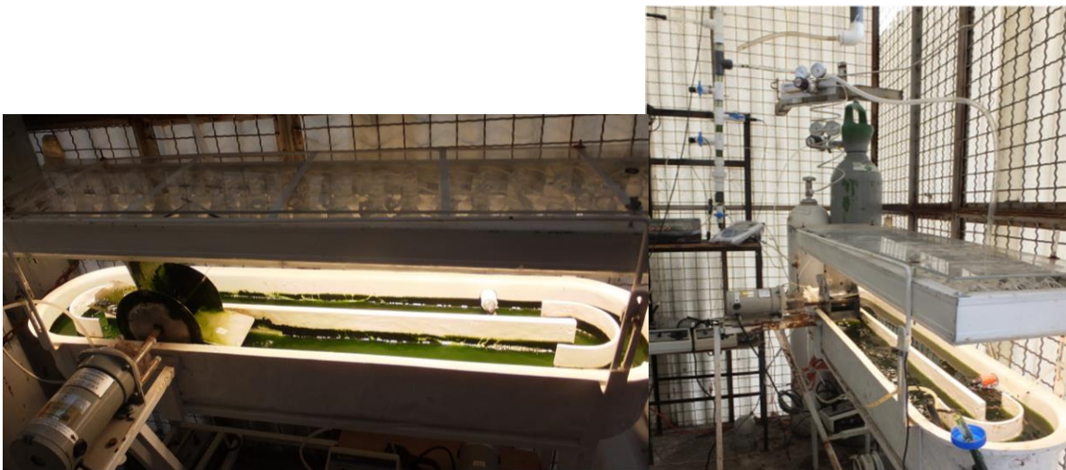
Figura 3.7 Esquema global del proceso de eliminación de efluentes provenientes de digestión anaerobia HRAP-ABC Medios sintéticos
