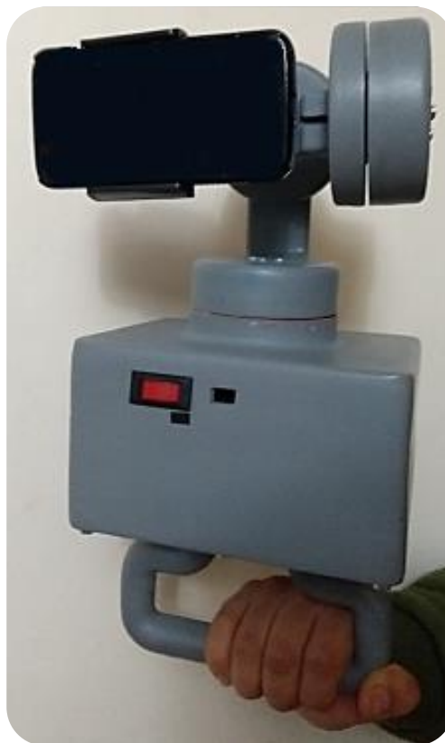
Figura 3.44 Dispositivo gimbal construido.
