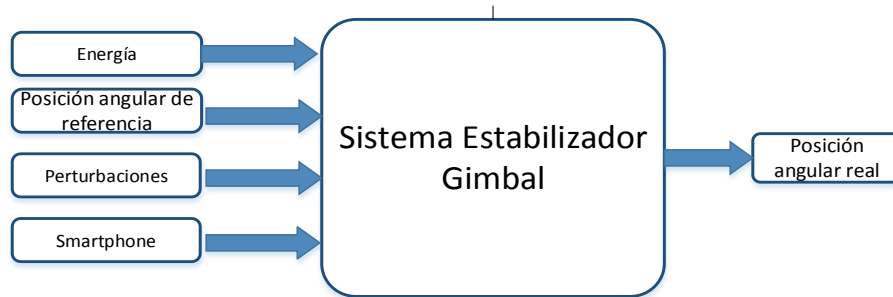
Figura 3.3 Sistema estabilizador gimbal como función general.
