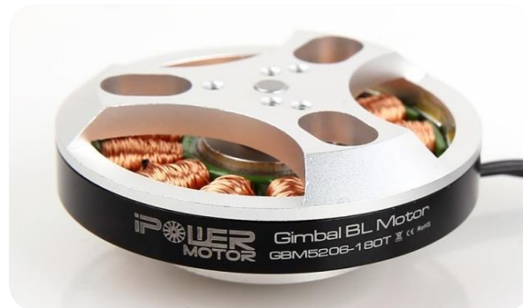
Figura 3.14 Actuador sin escobillas utilizado para el gimbal.
