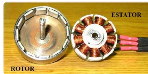
Figura 4.1 Rotor y estator de un BLDCM.
