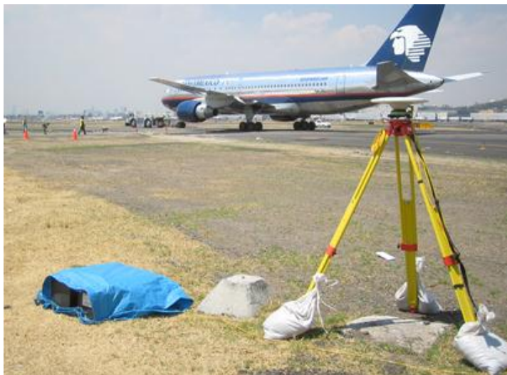
Fig. 3.2. Instalación completa de un equipo GPS Trimble5700.
