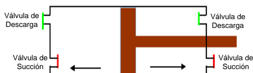
Figura 6.8. Compresor recíprocante de doble acción
