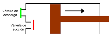
Figura 6.7. Compresor reciprocante de simple acción
