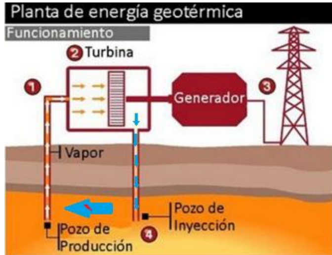
Fig.1. 3. Esquema de funcionamiento de una planta geotérmica. Extraída de comofuncionaque.
